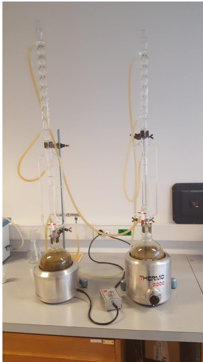
Slika 2.11. Hidrodestilacija korijena i nadzemnog dijela biljke L. graminifolium .
