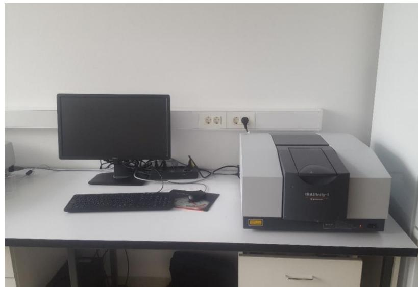
**Slika 2.20.** Infracrveni spektrofotometar s Fourirerovom transformacijom (IRAffinity-1, Shimadzu, Japan).
