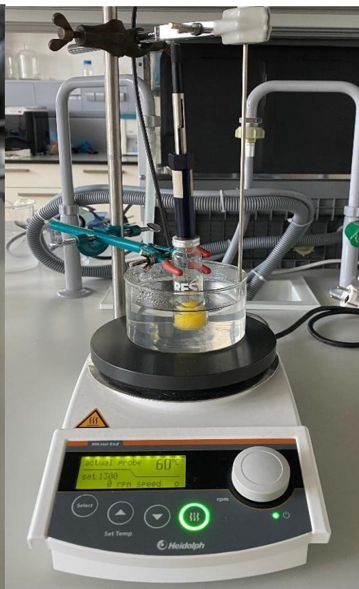
Slika 8. Aparatura za mikroekstrakciju vršnih para na čvrstoj fazi.
