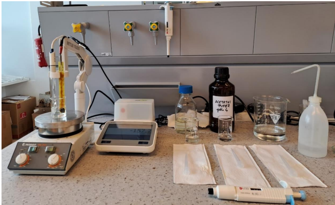
Slika 22. Aparatura korištena za potenciometrijska mjerenja
