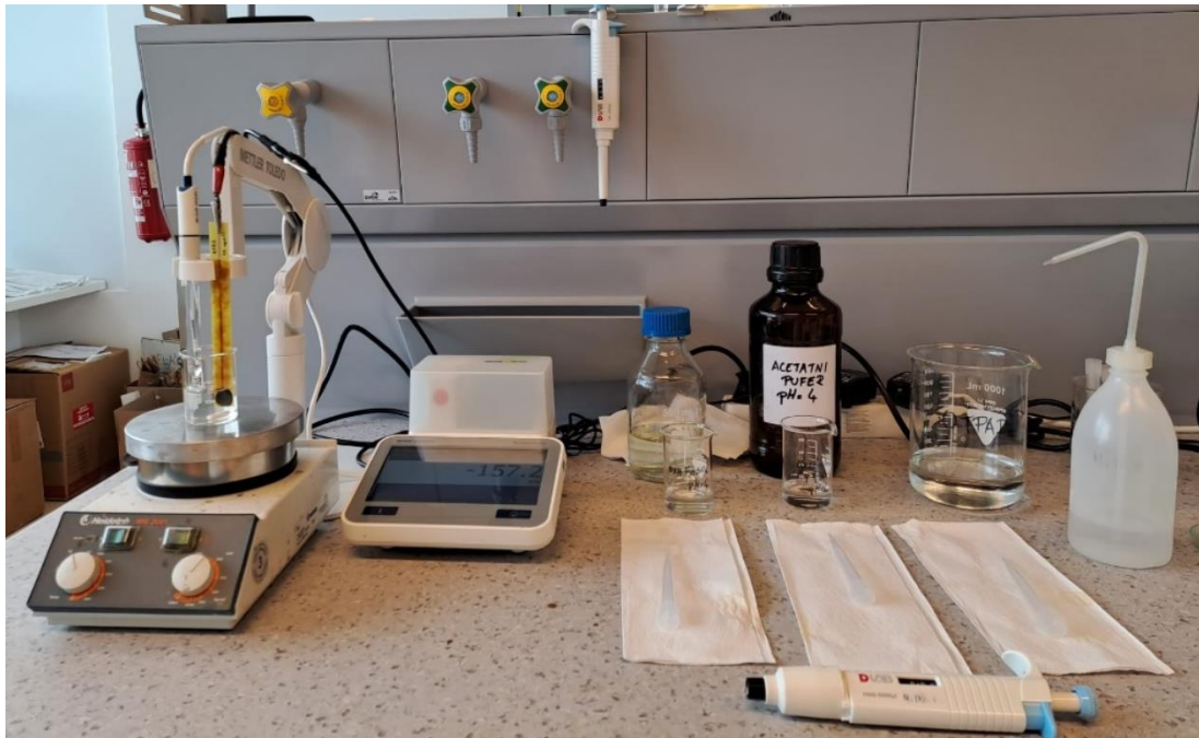
Slika 22. Aparatura korištena za potenciometrijska mjerenja
