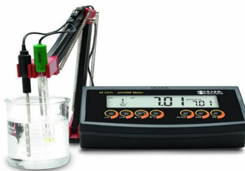
Slika 17. Određivanje pH vrijednosti pomoću digitalnog pH-metra
