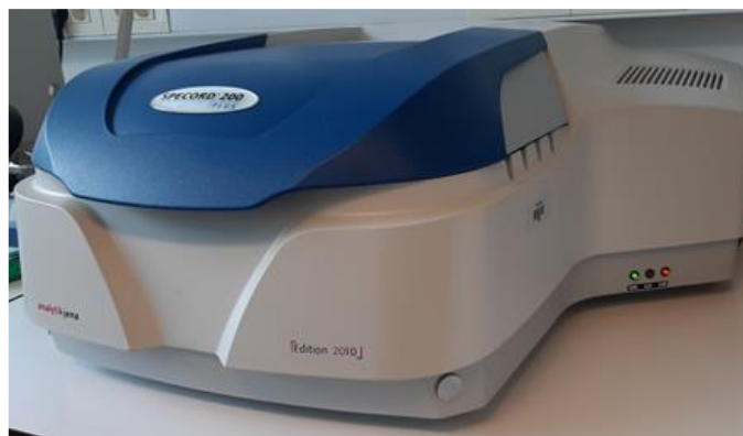
Slika 13. Spektrofotometar SPECORD 200 Plus
