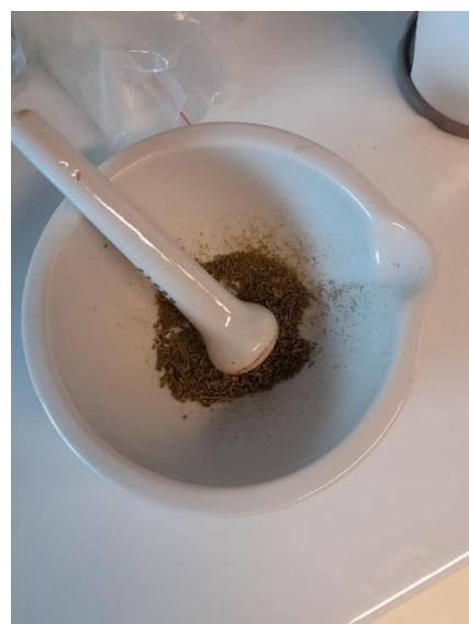
**Slika 12.** Liofiliziran i usitnjen uzorak motra
