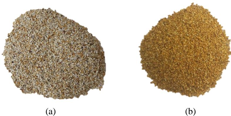
Slika 2.1. Usporedba (a) prirodnog i (b) Fe(III)-modificiranog zeolita.
