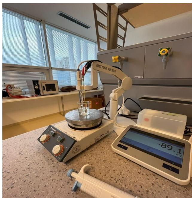
*Slika 12.* Prikaz potenciometrijskog mjernja
