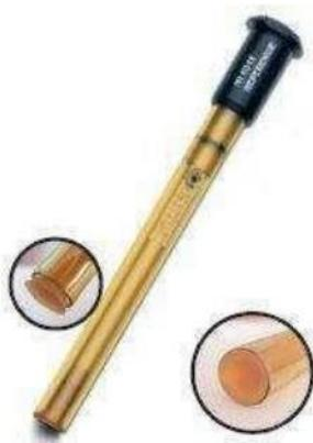
Slika 2. Izgled dvospojne referentne elektrode<sup>3</sup>
