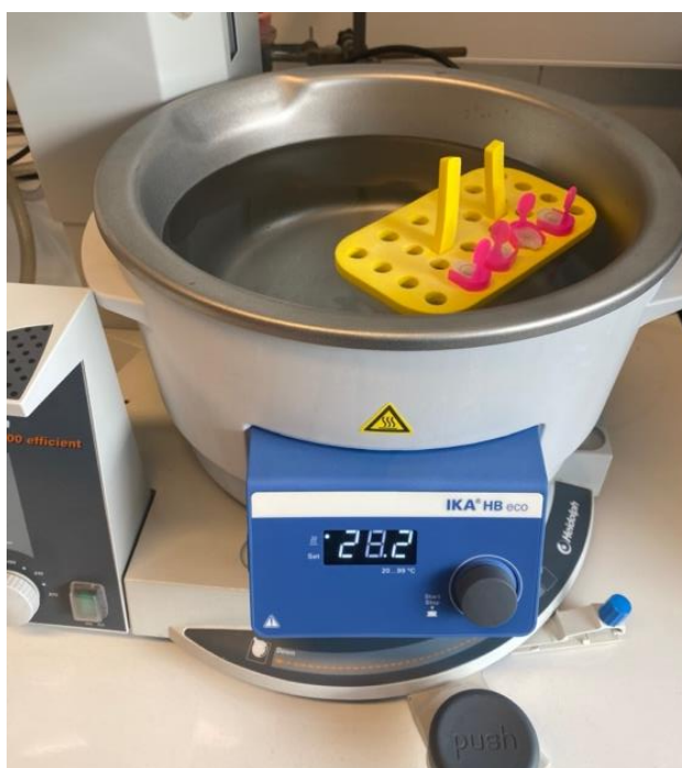
Slika 16. Zagrijavanje na vodenoj kupelji.
