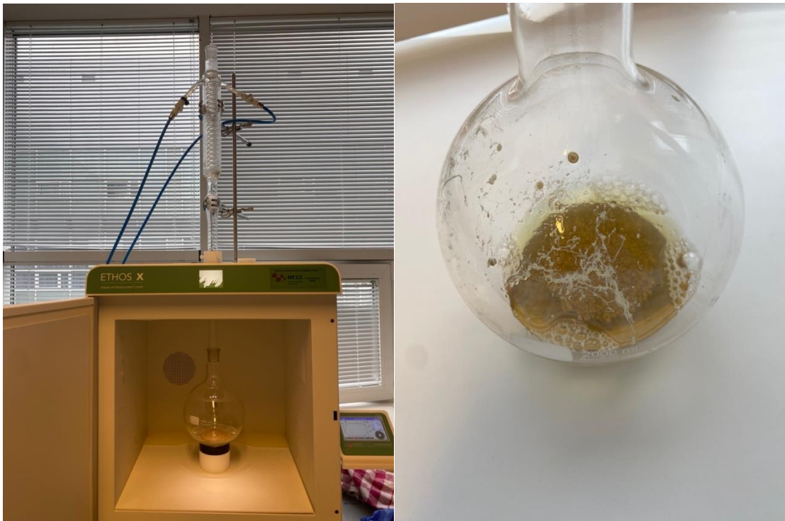
Slika 13. Bijela gorušica tijekom i nakon mikrovalne destilacije (800 W)
