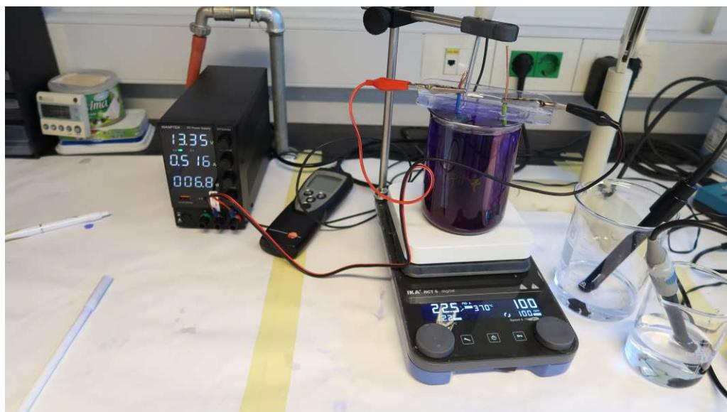
**Slika 20.** Aparatura korištena za provedbu postupka elektrokoagulacije
