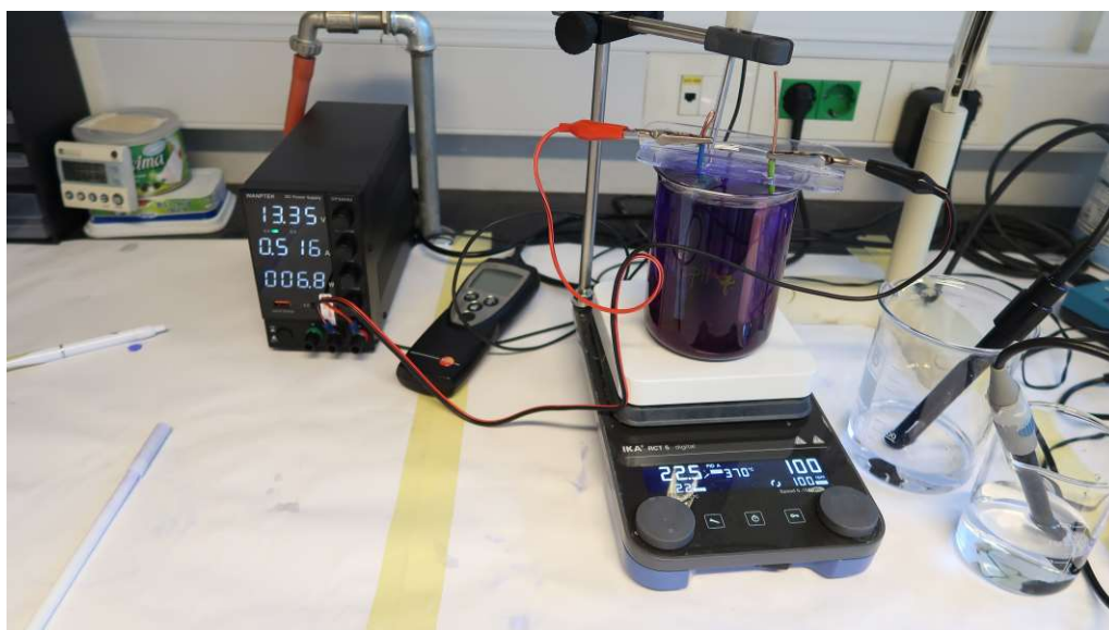
Slika 20. Aparatura korištena za provedbu postupka elektrokoagulacije
