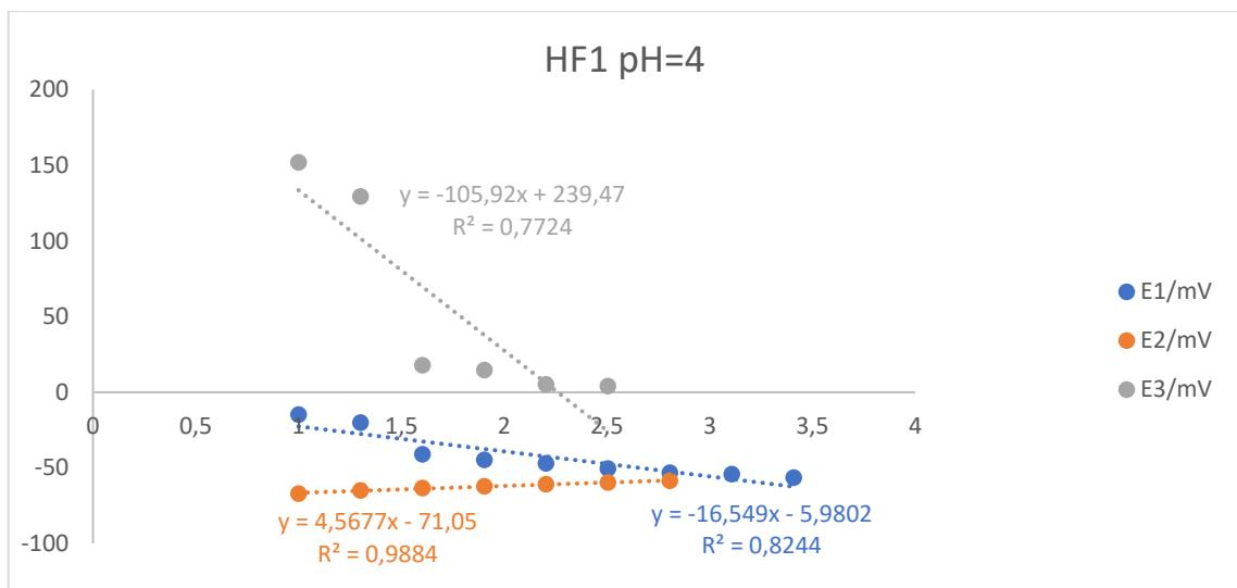
Slika 2-5 Grafički prikaz ovisnosti elektrodnog potencijala membrane HF1 o koncentraciji  $\text{Fe}^{3+}$  iona
