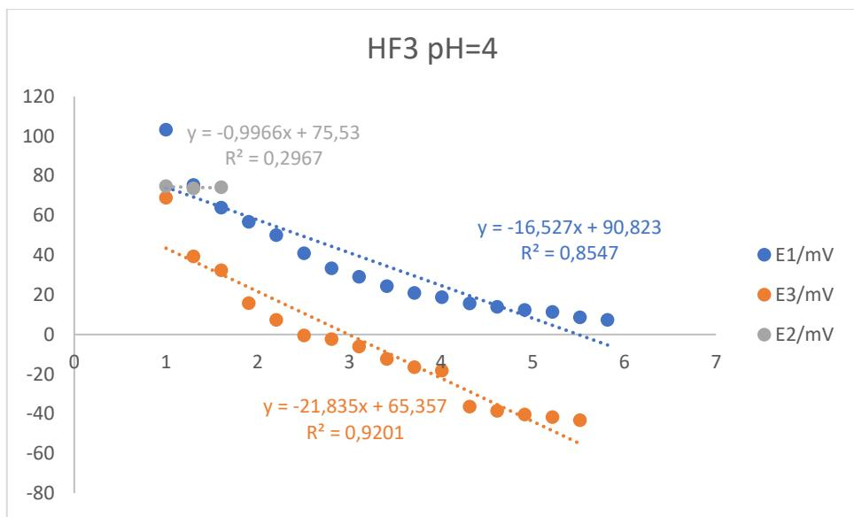
Slika 2-7 Grafički prikaz ovisnosti elektrodnog potencijala membrane HF3 o koncentraciji  $\text{Fe}^{3+}$  iona
