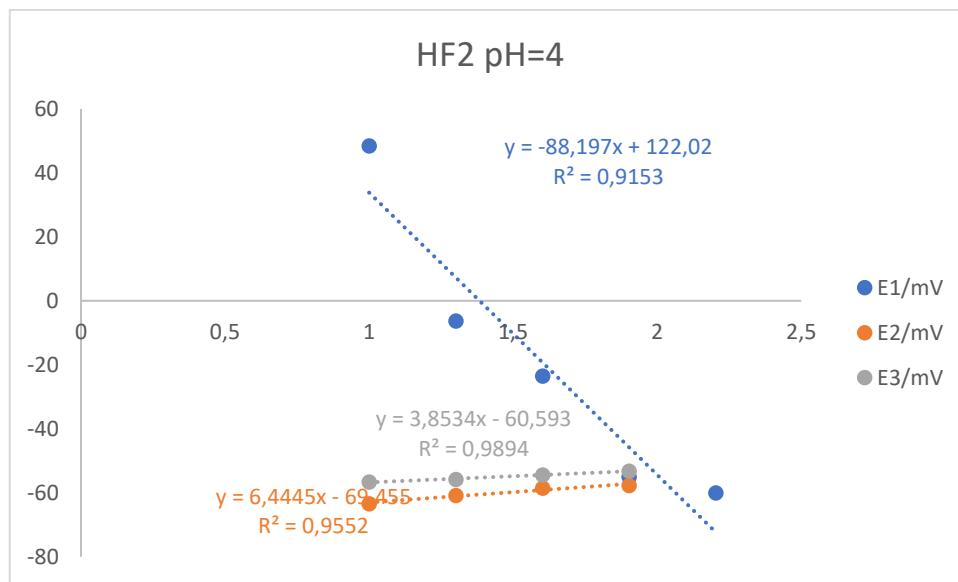
Slika 2-6 Grafički prikaz ovisnosti elektrodnog potencijala membrane HF2 o koncentraciji Fe<sup>3+</sup> iona
