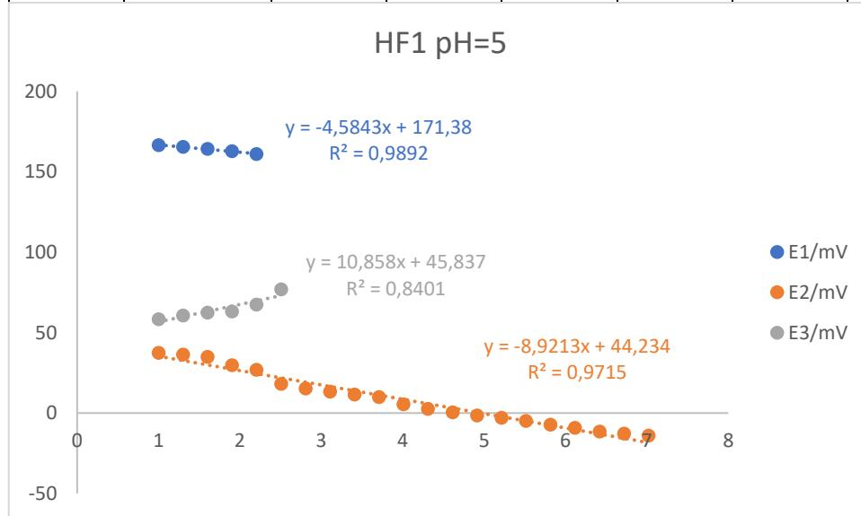
Slika 2-8 Grafički prikaz ovisnosti elektrodnog potencijala membrane HF1 o koncentraciji Fe3+ iona
