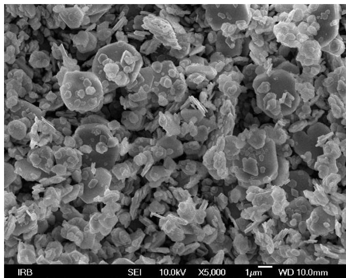
Slika 2-3 SEM slika iregularnih čestica hematita
