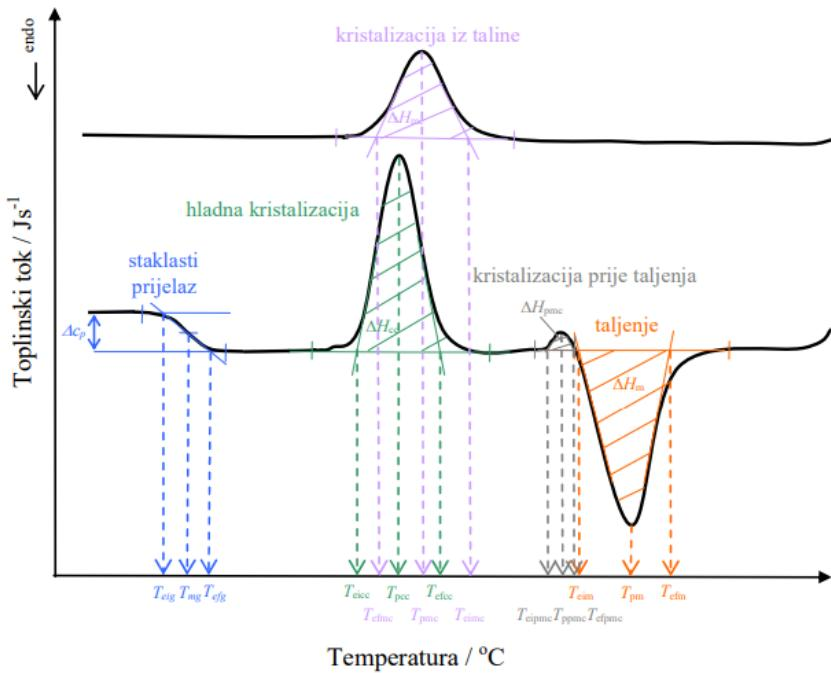
Slika 7. Određivanje značajki krivulje diferencijalne pretražne kalorimetrije<sup>12</sup>
