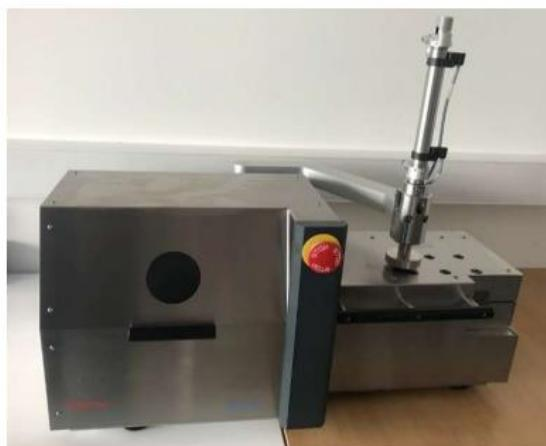
**Slika 6.** Laboratorijski dvopužni ekstruder HAAKE MiniLab 3
