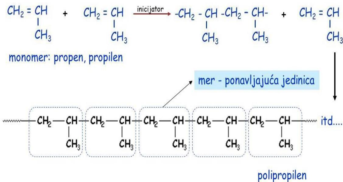
**Slika 1.** Mehanizam lančane radikalne reakcije polimerizacije propilena u polipropilen<sup>2</sup>
