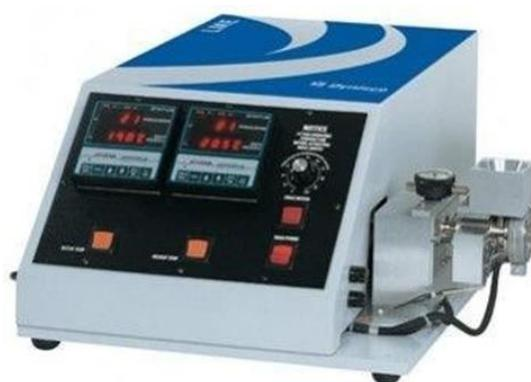
SLIKA 10. Jednopužni laboratorijski ekstruder DYNISCO LME 230
