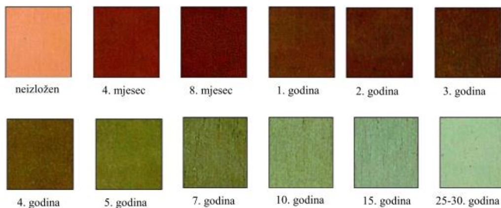
Slika 31. Promjena boje patine na bakru tijekom vremena. 23
