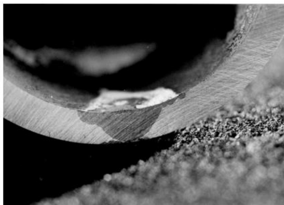
Slika 17. Primjer selektivne korozije. 1
