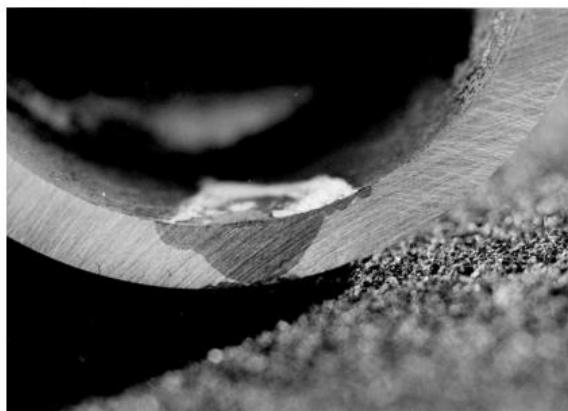
Slika 17. Primjer selektivne korozije. 1
