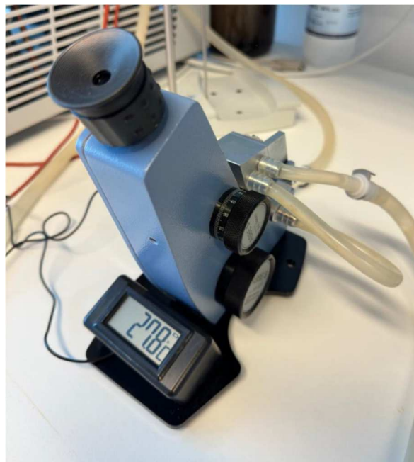
Slika 10. Refraktometar korišten pri provedbi eksperimenta.
