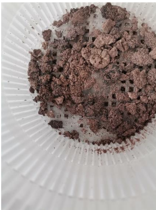
Slika 22. Prah dobiven nakon mljevenja liofiliziranih uzoraka kultivirane borovnice koristeći kuglični mlin
