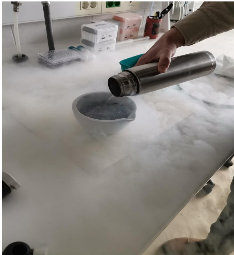
Slika 10. Smrzavanje borovnica u struji tekućeg dušika
