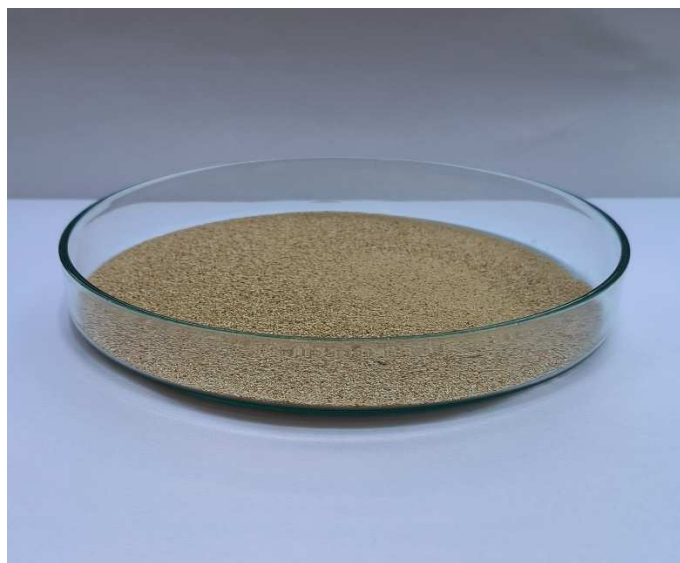
Slika 2.7. Uzorak prirodnog zeolita veličine 0,09 – 0,56 mm.
