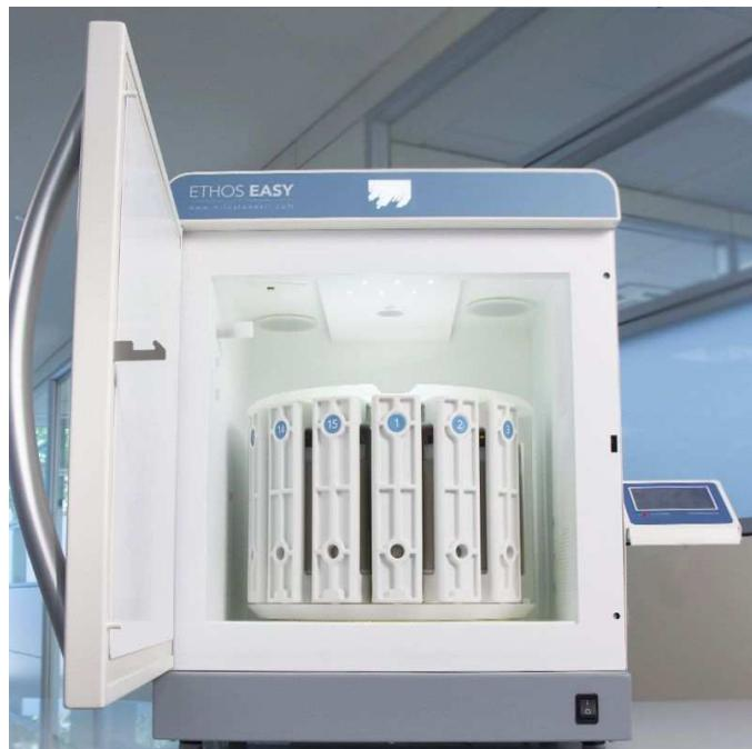
**Slika 2.10.** Mikrovalni digestor.
