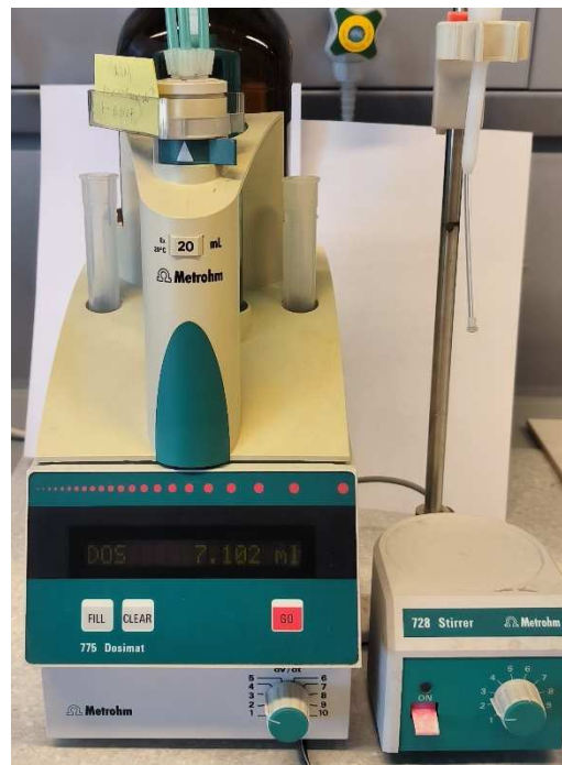
Slika 2.1. Automatski titrator „Metrohm 7775 Dosimat“.
