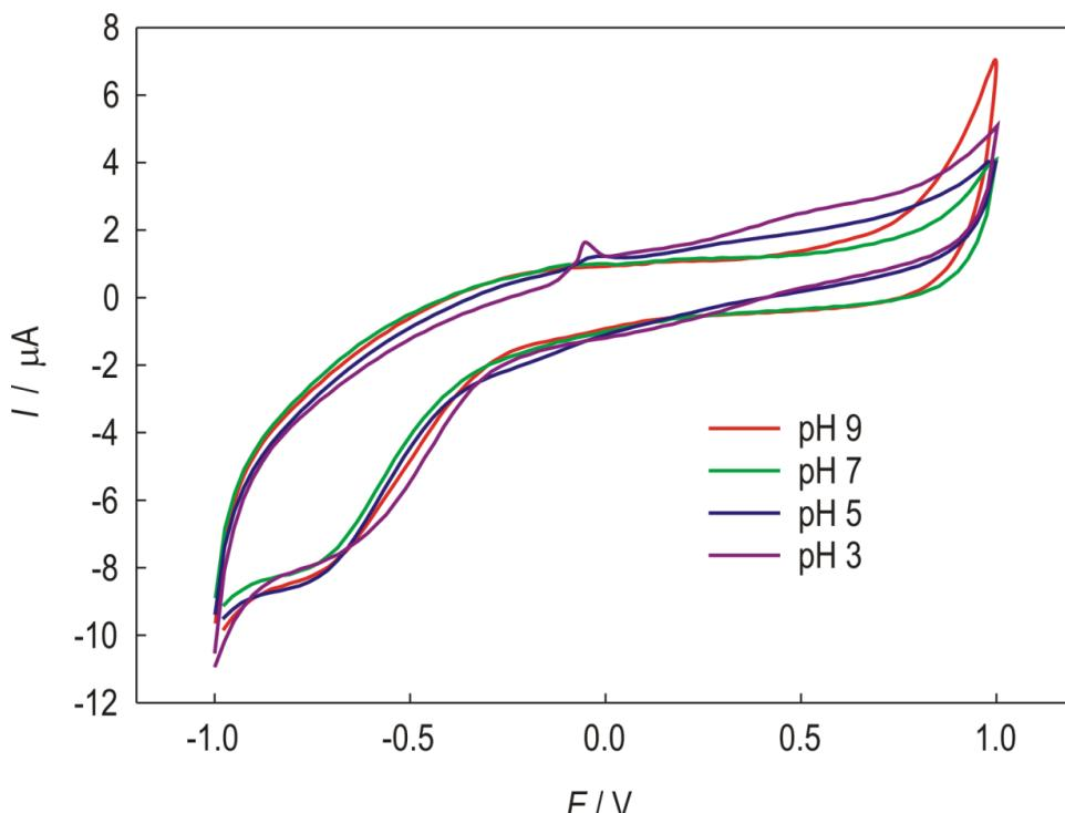
**Slika 23.** Ciklički voltamogrami GC/SWCNT/Bi pri različitom pH fosfatnog elektrolita uz brzinu promjene potencijala 25 mV/s.
