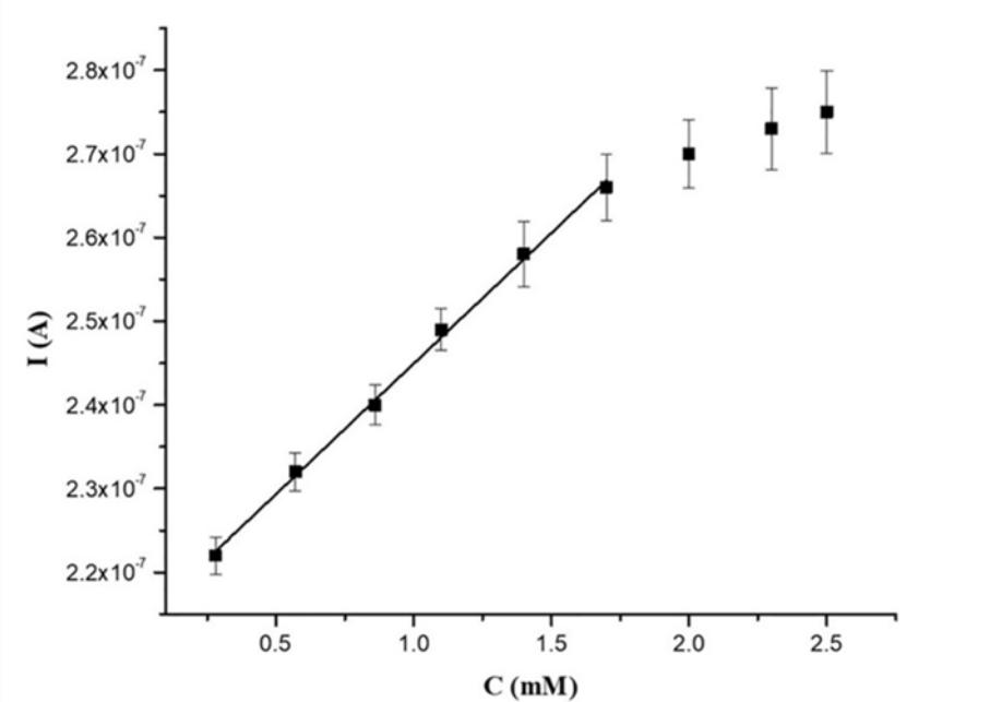
**Slika 16.** Kalibracijska krivulja koja pokazuje odgovor struje biosenzora na promjenu koncentracije glukoze (s relativnom pogreškom).<sup>29</sup>
