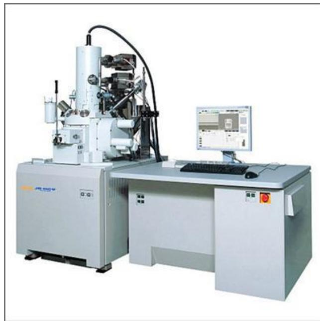
**Slika 4.** Pretražni elektroniski mikroskop.<sup>10</sup>
