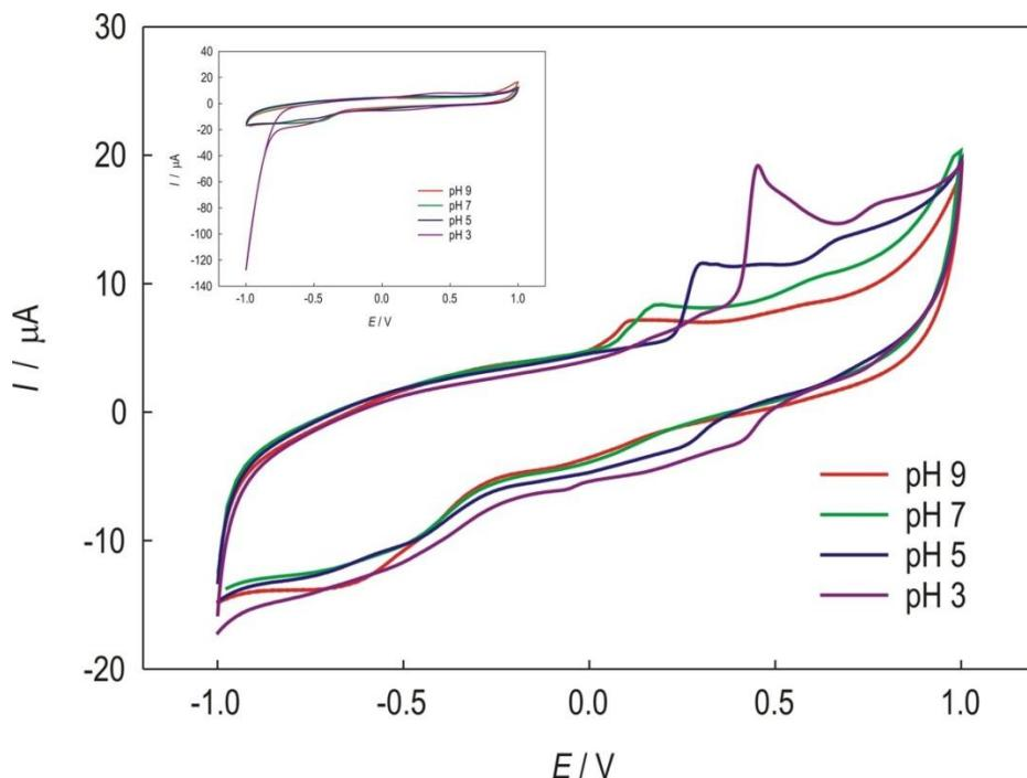
**Slika 29.** Ciklički voltamogrami GC/SWCNT pri različitom pH fosfatnog elektrolita uz brzinu promjene potencijala 25 mV/s uz dodatak galne kiseline,  $1 \times 10^{-4}$  mol dm $^{-3}$ . Isječak: GC/SWCNT bez analita.
