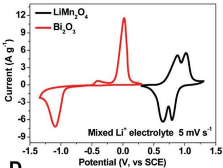
**Slika 18.** Usklađeni ciklički voltamogrami LiMn<sub>2</sub>O<sub>4</sub> katode i Bi<sub>2</sub>O<sub>3</sub> anode bez vezivnog materijala.<sup>30</sup>
