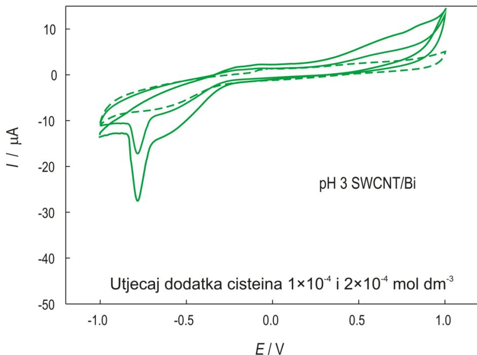
**Slika 38.** Ciklički voltamogrami GC/SWCNT/Bi pri pH3 uz brzinu promjene potencijala 25 mV/s bez i uz dodatak cisteina,  $1 \times 10^{-4}$  mol dm $^{-3}$  i  $2 \times 10^{-4}$  mol dm $^{-3}$ .
