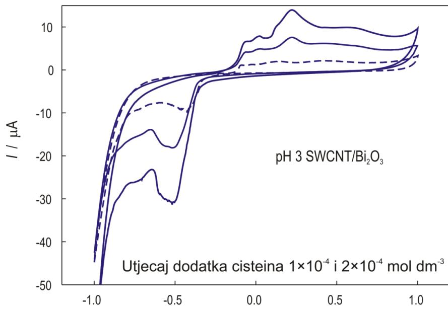
**Slika 39.** Ciklički voltamogrami GC/SWCNT/Bi<sub>2</sub>O<sub>3</sub> pri pH3 uz brzinu promjene potencijala 25 mV/s bez i uz dodatak cisteina,  $1 \times 10^{-4}$  mol dm<sup>-3</sup> i  $2 \times 10^{-4}$  mol dm<sup>-3</sup>.
