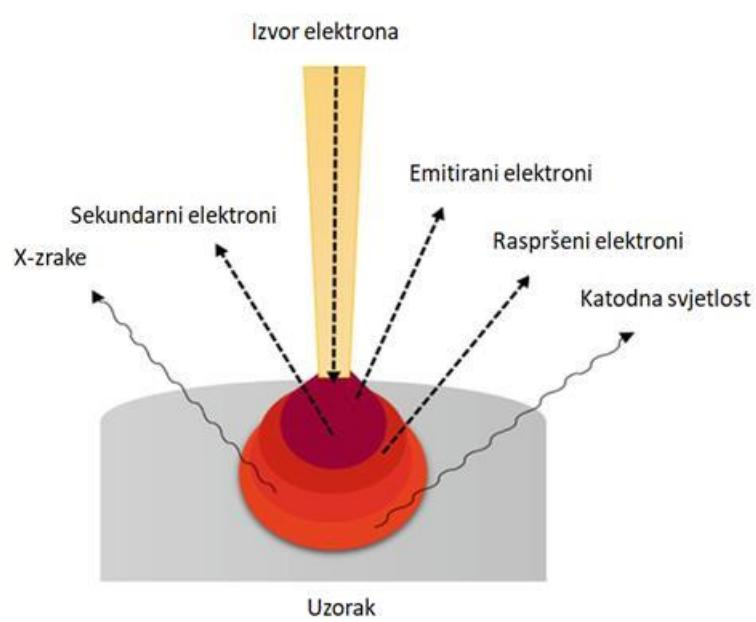
**Slika 5.** Princip rada SEM mikroskopa.<sup>11</sup>
