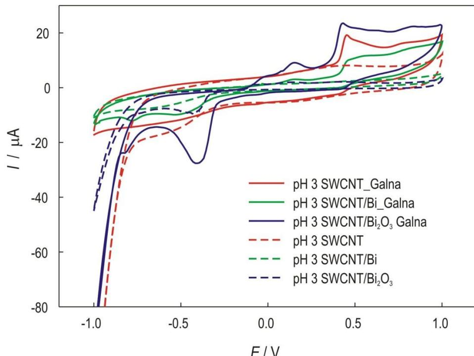
**Slika 35.** Usporedba svih pripravljenih elektroda prema galnoj kiseline bez i uz dodatak galne kiseline,  $1 \times 10^{-4} \text{ mol dm}^{-3}$ .
