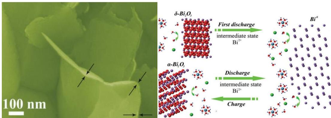
**Slika 17.** (Lijevo) Prikaz bizmutovih(III) oksid nanolatica i (desno) reakcija oksidacije bizmutova(III) oksida.<sup>30</sup>
