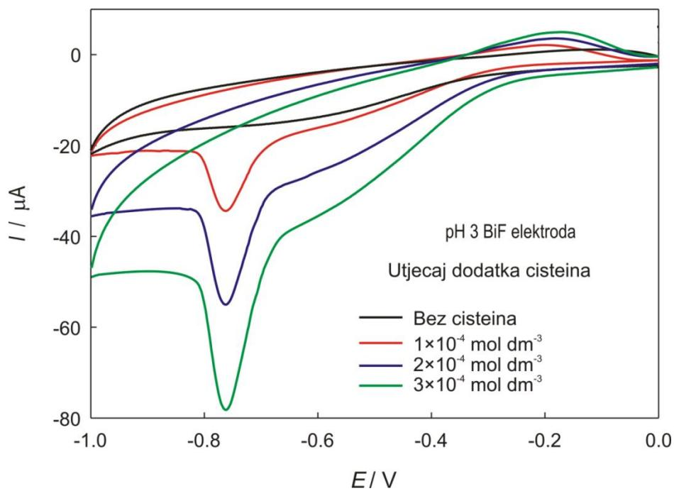
**Slika 42.** Ciklički voltamogrami BiF elektrode pri pH3 uz brzinu promjene potencijala 25 mV/s bez i uz dodatak cisteina,  $1 \times 10^{-4}$  mol dm<sup>-3</sup>,  $2 \times 10^{-4}$  mol dm<sup>-3</sup> i  $3 \times 10^{-4}$  mol dm<sup>-3</sup>.
