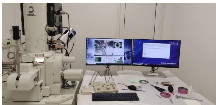
Slika 20. SEM/EDS JEOL JSM – 7610F Plus.
