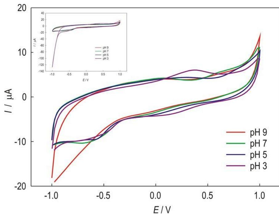
**Slika 32.** Ciklički voltamogrami GC/SWCNT pri različitom pH fosfatnog elektrolita uz brzinu promjene potencijala 25 mV/s uz dodatak cisteina,  $1 \times 10^{-4}$  mol dm $^{-3}$ . Isječak: GC/SWCNT bez analita.
