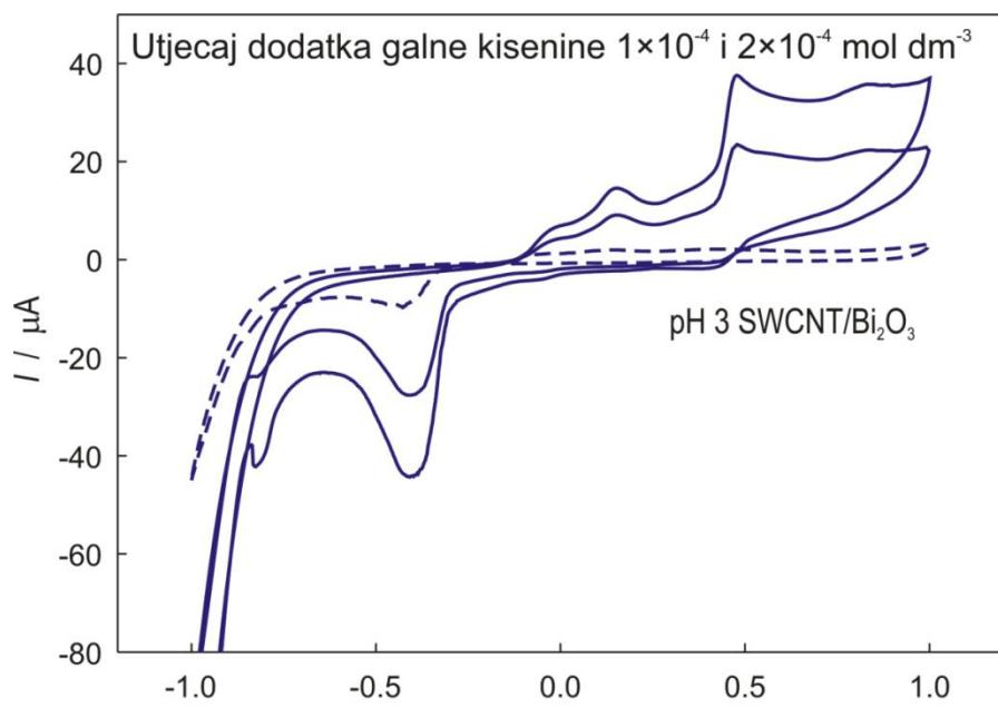
**Slika 36.** Ciklički voltamogrami GC/SWCNT/Bi<sub>2</sub>O<sub>3</sub> pri pH3 uz brzinu promjene potencijala 25 mV/s bez i uz dodatak galne kiseline,  $1 \times 10^{-4}$  mol dm<sup>-3</sup> i  $2 \times 10^{-4}$  mol dm<sup>-3</sup>.
