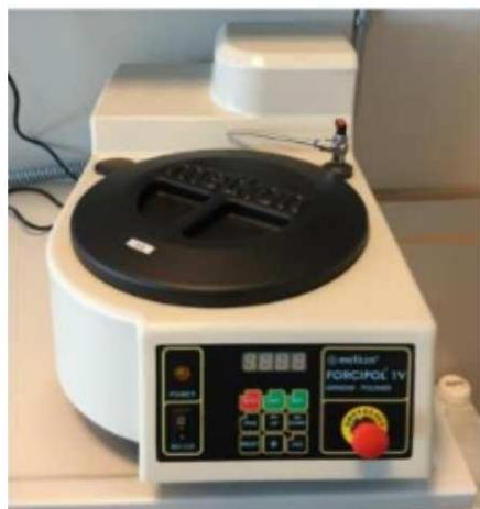
**Slika 11.** Metalografska brusilica Metkon Forcipol 1 V
