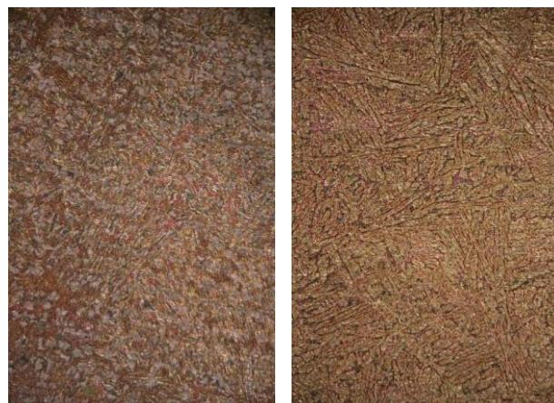
**Slika 25.** Površina CuAl uzorka nakon PD mjerena u morskoj vodi pri  $T=20^{\circ}\text{C}$ : a) u mirujućoj otopini, b) uz miješanje magnetskom miješalicom  $200 \text{ o min}^{-1}$
