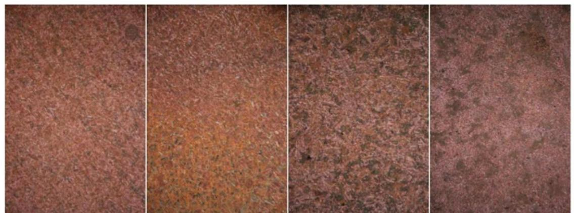
**Slika 24.** Površina Cu uzorka nakon PD mjerena u mirujućoj morskoj vodi različitim temperaturama: a)  $T=10^{\circ}\text{C}$ , b)  $T=20^{\circ}\text{C}$ , c)  $T=30^{\circ}\text{C}$ , d)  $T=40^{\circ}\text{C}$
