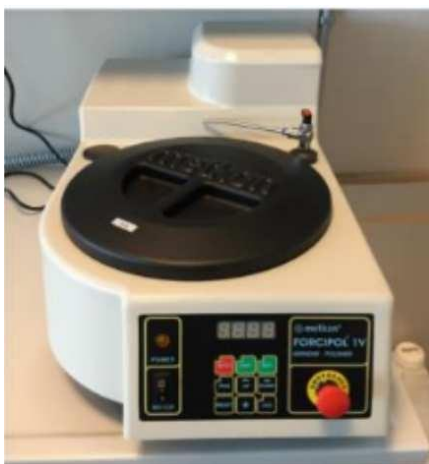
Slika 11. Metalografska brusilica Metkon Forcipol 1 V
