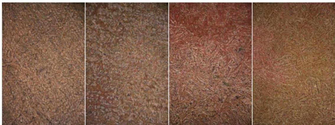
**Slika 26.** Površina CuAl uzorka nakon PD mjerena u mirujućoj morskoj vodi različitim temperaturama: a)  $T=10^{\circ}\text{C}$ , b)  $T=20^{\circ}\text{C}$ , c)  $T=30^{\circ}\text{C}$ , d)  $T=40^{\circ}\text{C}$
