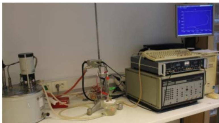
Slika 12. Potencijostat/galvanostat PAR 273A povezan s elektrodama u elektrokemijskoj ćeliji
