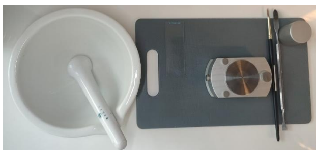
Slika 13. Pribor potreban za usitnjavanje uzorka
