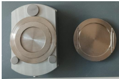
Slika 15. Prikaz donjeg i gornjeg držača uzorka za XRD analizu
