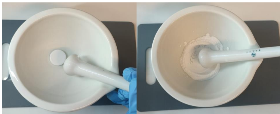
Slika 14. Uzorak Magnezij 375 prije usitnjavanja a) i nakon usitnjavanja b).
