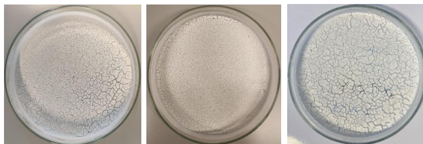
Slika 13. Izgled suhih uzoraka nakon sušenja pri 80°C u trajanju od 2 sata
