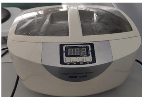
Slika 21. Ultrazvučna kupelj, Digital Ultrasonic Cleaner (35 kHz, 60 W)
