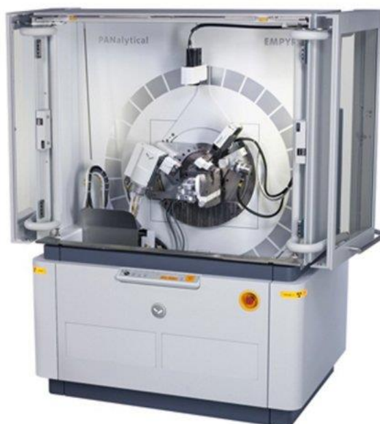
Slika 15. Uređaj za mjerenje difrakcije zraka na polikristalnim uzorcima, Empyrean, Malvern Panalytical
