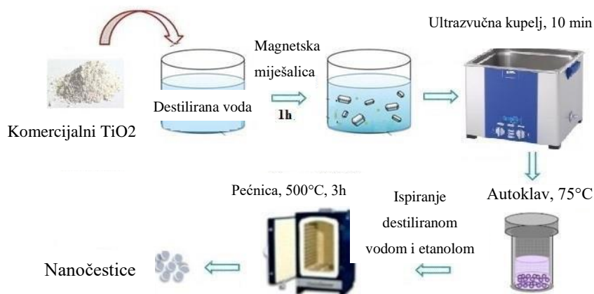
Slika 9. Primjer sinteze nanostrukturiranog \text{TiO}_2 hidrotermalnom metodom 25
