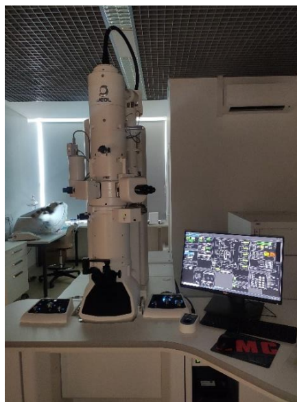
Slika 17. Jeol JEM 1400Flash elektronski mikroskop
