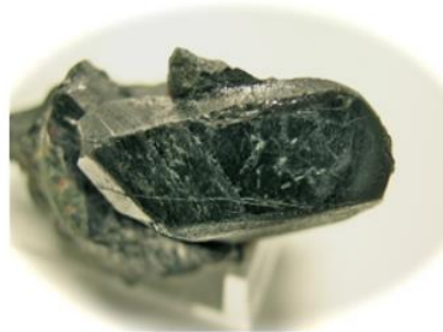
Slika 1. Prikaz titanijeve rude ilmenit ( \text{FeTiO}_3 ) 1
