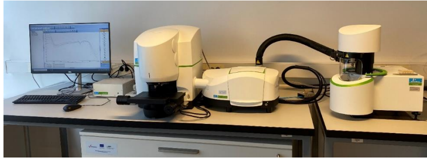
Slika 16. FT-IR spektrometar Spectrum Two, Perkin Elmer
