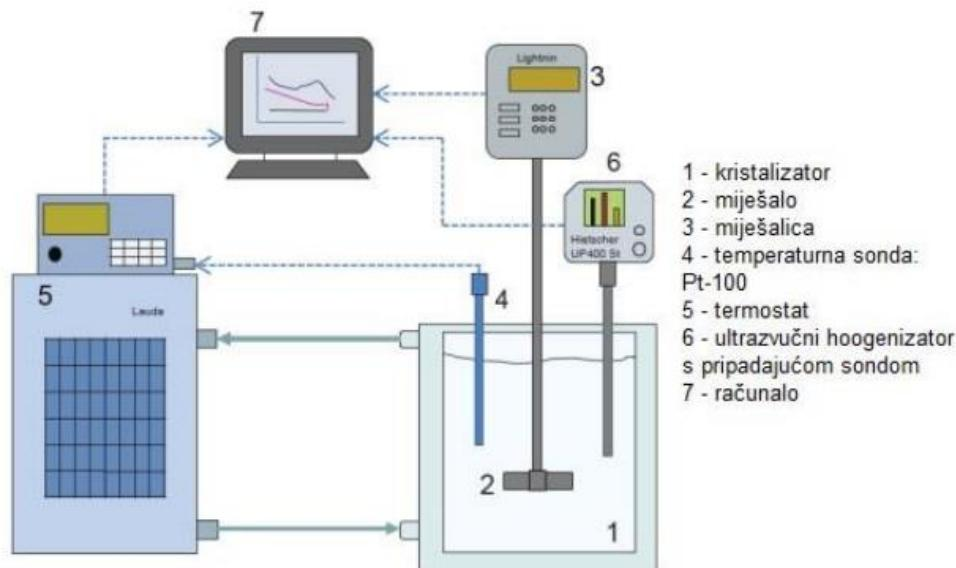
Slika 11. Aparatura za provedbu eksperimenta.<sup>2</sup>
