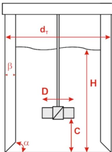
**Slika 12.** Geometrijske karakteristike kristalizatora.<sup>14</sup>
