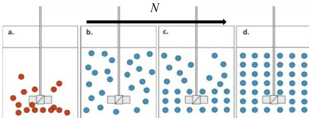
**Slika 9.** Stanja suspenzije: (a) nepotpuna suspenzija, (b) potpuna suspenzija,
