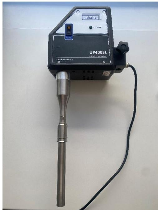
**Slika 15.** Ultrazvučni homogenizator Hielscher UP400St.
