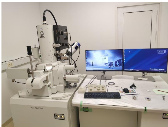
Slika 13. Jeol JEM -7610F Plus pretražni elektronski mikroskop
