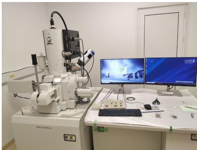
Slika 13. Jeol JEM -7610F Plus pretražni elektronski mikroskop
