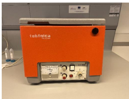
Slika 8. Centifuga Tehnica železniki, LC-32
