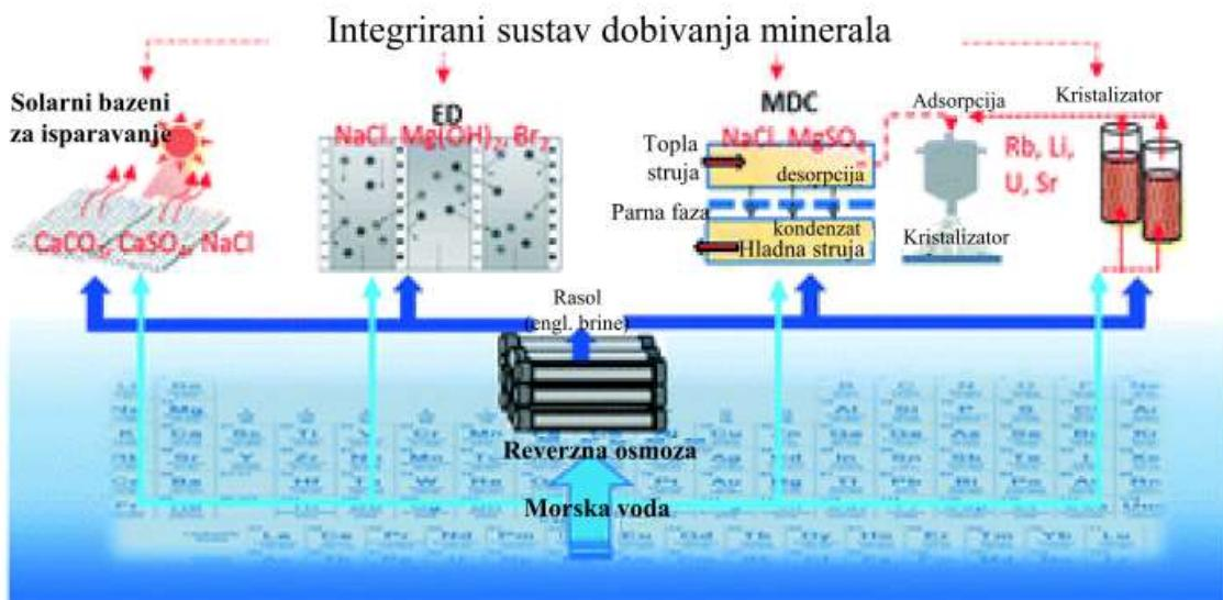
Slika 4. Integrirani sustav dobivanja minerala izravno iz morske vode ili iz koncentriranog rasola dobivenog kao nusproizvod u procesu desalinizacije<sup>5</sup>
