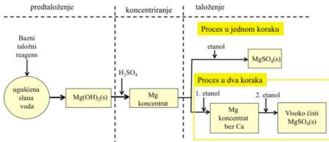
Slika 14. Dijagram toka za izdvajanje magnezija iz ugušćene slane vode nakon procesa desalinizacije<sup>25</sup> u obliku  $\text{MgSO}_4$
