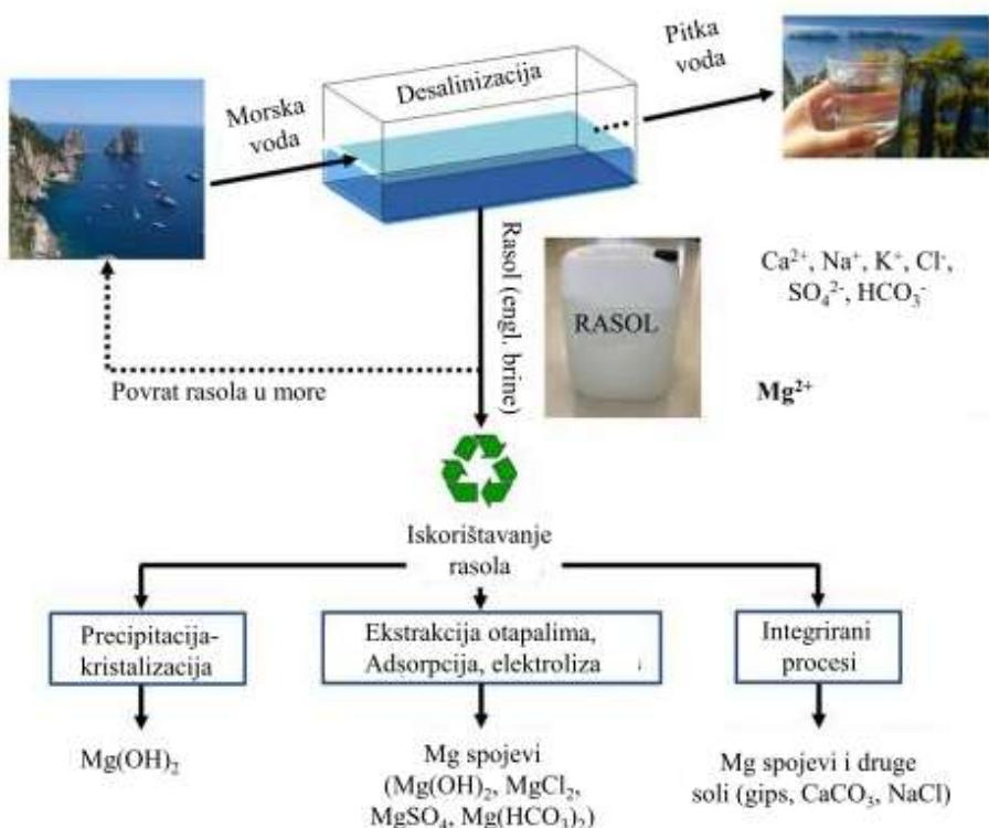
Slika 12. Shematski prikaz dobivanja magnezijevih spojeva iz zaostale ugušćene slane vode nakon procesa desalinizacije<sup>6</sup>
