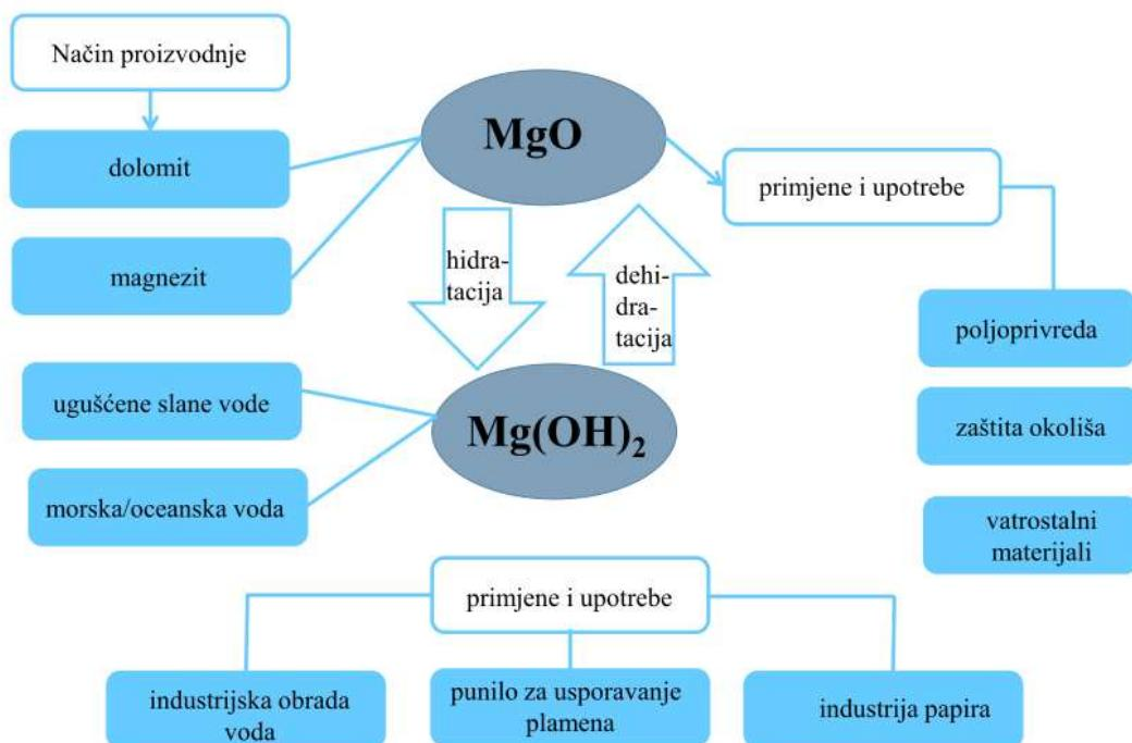
Slika 10. Shematski prikaz načina proizvodnje i upotreba  $MgO$  i  $Mg(OH)_2$ <sup>19</sup>
