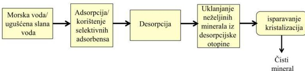
Slika 3. Shematski prikaz adsorpcija/desorpcija procesa za dobivanja minerala iz morske vode i/ili ugušćene morske vode nakon desalinizacije (rasola)<sup>5</sup>
