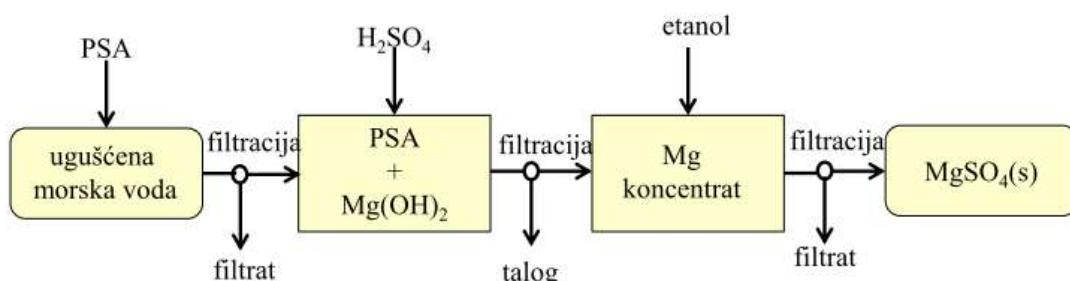
Slika 13. Tri stupnja izdvajanja magnezija iz ugušćene morske vode nakon procesa desalinizacije<sup>24</sup>
