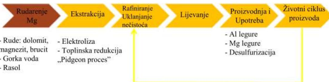
Slika 11. Shema redoslijeda postupaka pri komercijalnoj proizvodnji metalnog magnezija. Narančastom bojom prikazan je redoslijed postupaka koji se odvijaju u EU<sup>6</sup>
