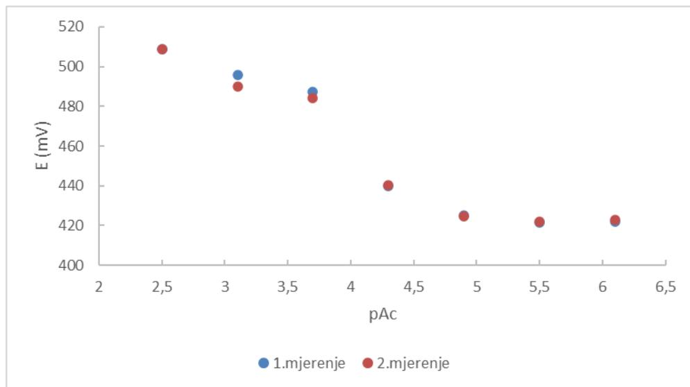
**Slika 15.** Ovisnost promjene potencijala za elektrodu 3 o negativnom logaritmu koncentracija radnih otopina acebutolola
