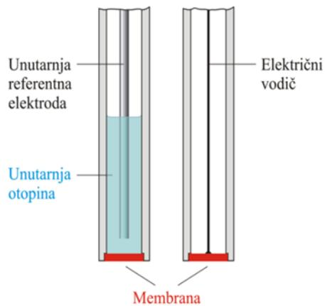
Slika 2. Ionsko-selektivne elektrode<sup>3</sup>
