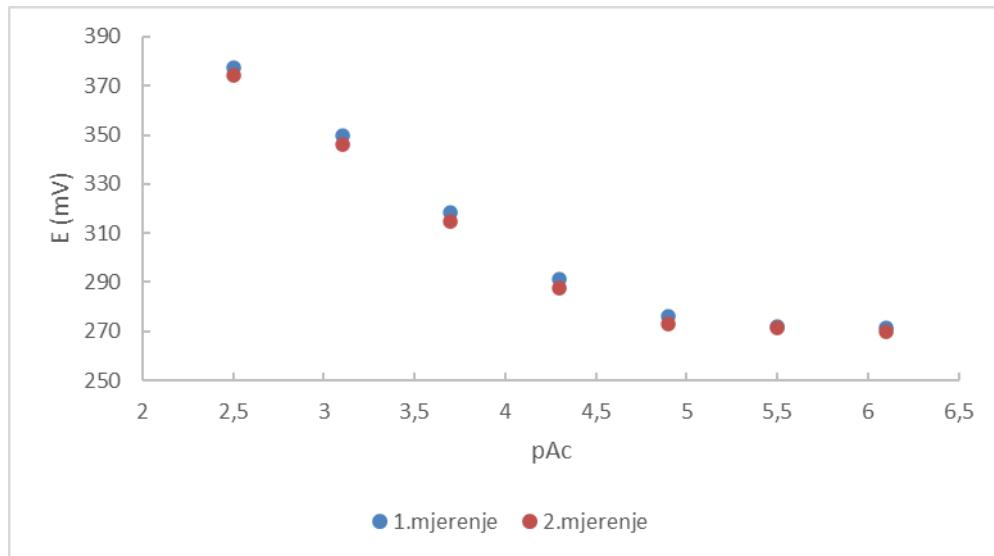
**Slika 17.** Ovisnost promjene potencijala za elektrodu 5 o negativnom logaritmu koncentracija radnih otopina acebutolola
