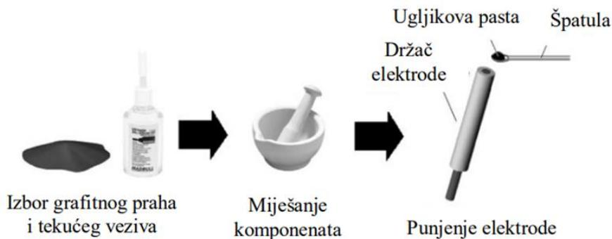
**Slika 3.** Prikaz pripreme elektrode s ugljikovom pastom<sup>8</sup>
