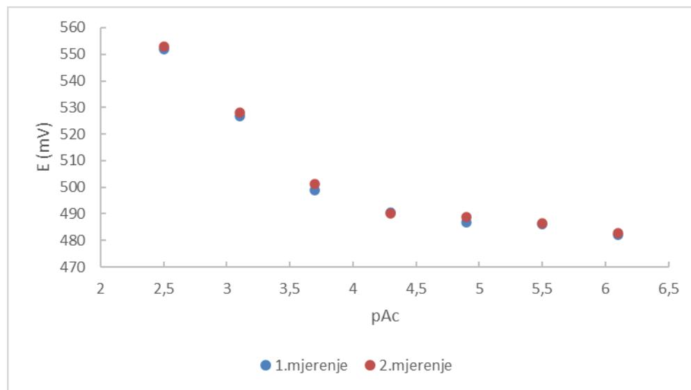
**Slika 14.** Ovisnost promjene potencijala za elektrodu 2 o negativnom logaritmu koncentracija radnih otopina acebutolola
