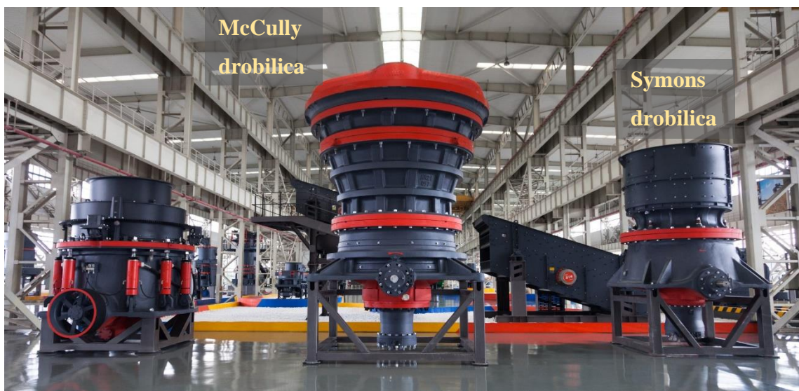
Slika 7. Kružna (McCully) i konusna (Symons) drobilica u industrijskom pogonu.
