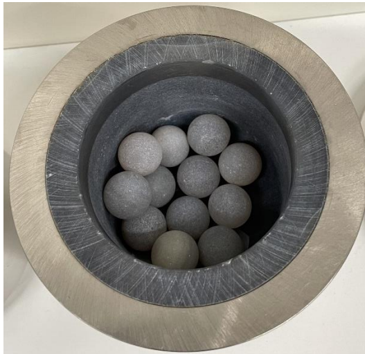
Slika 13. Ispunjenost kugličnog mlina s kuglama.
