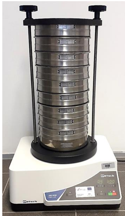
Slika 18. Mehanička tresilica tipa Retsch AS 200 sa serijom sita.
