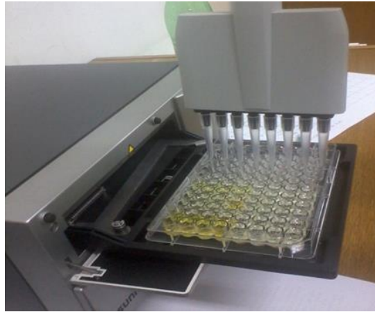
Slika 21. Poluautomatska pipeta i višekanalni čitač mikrotitarskih pločica "Sunrise" 10
