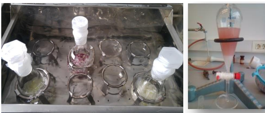
Slika 18. Autoliza na vodenoj kupelji i ekstrakcija
