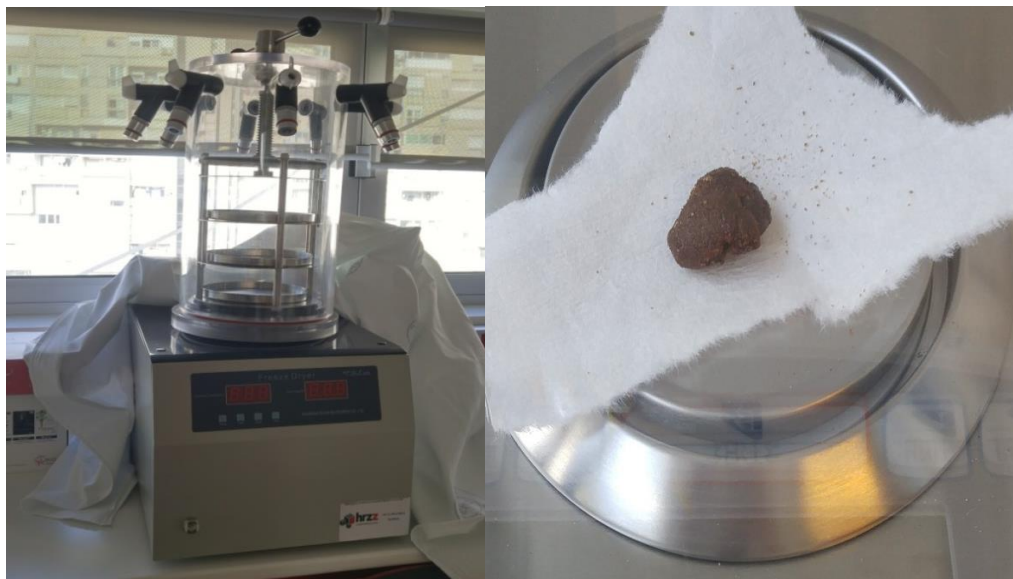
Slika 17. Liofilizator i liofilizirani uzorak crvenog luka
