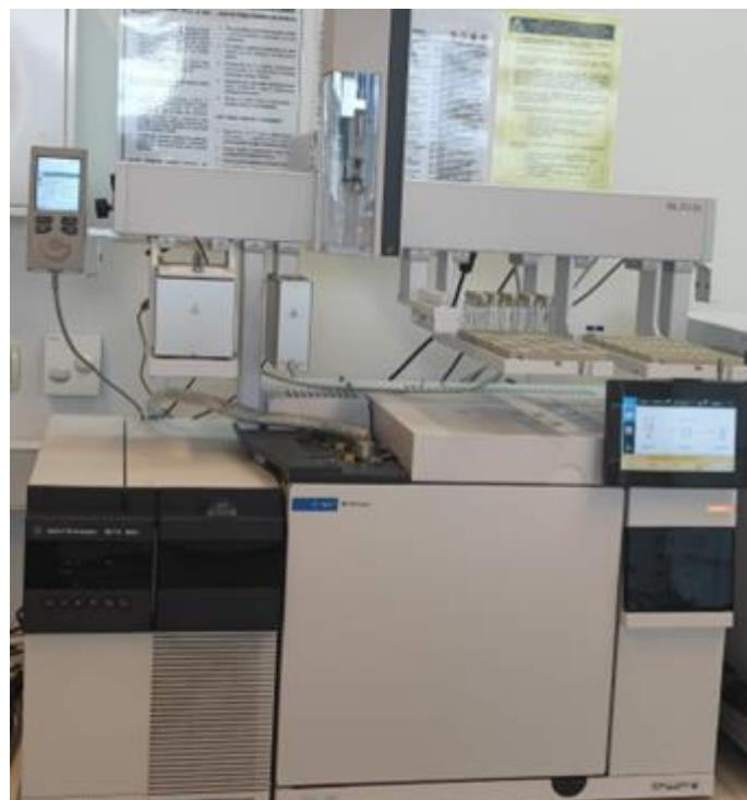
Slika 11. Plinska kromatografija sa spektrometrijom masa (GC-MS)
