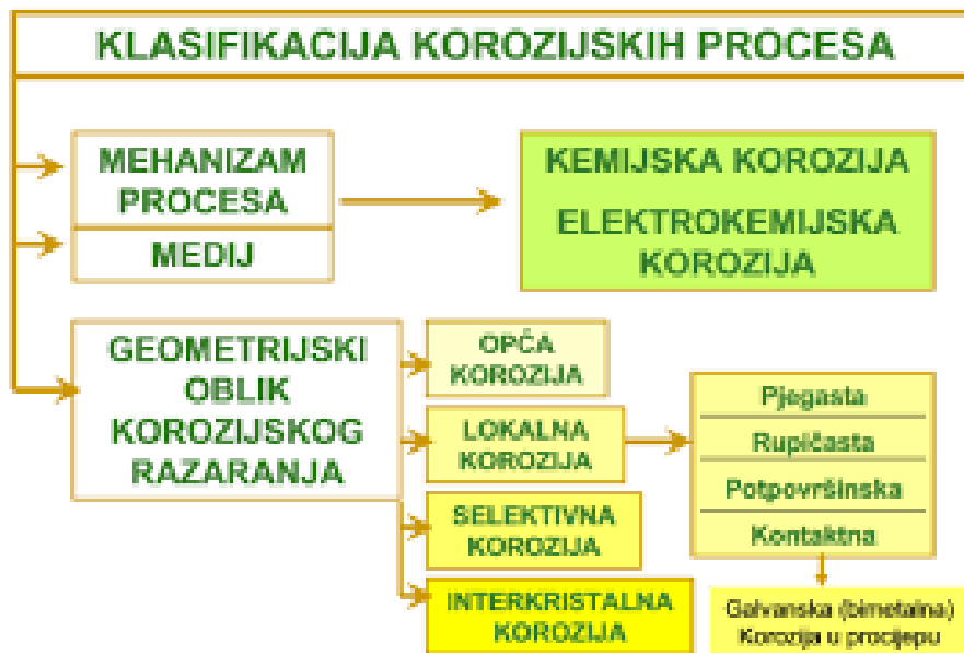
Slika 1.5. Shematski prikaz klasifikacije korozijskih procesa 11
