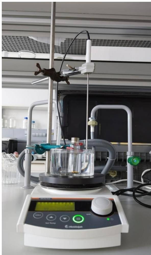
Slika 16. Aparatura za mikroekstrakciju vršnih para na krutoj fazi (HS-SPME) (vlastita fotografija)
