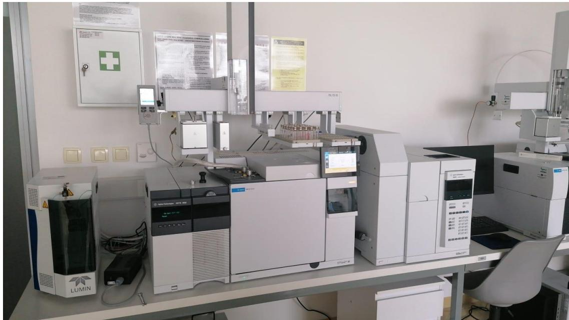
Slika 18. Vezani sustav plinska kromatografija- spektrometrija masa (GC-MS) (vlastita fotografija)
