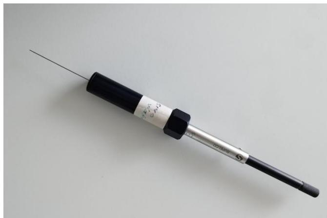
Slika 19. Uređaj za mikroekstrakciju (vlastita fotografija)
