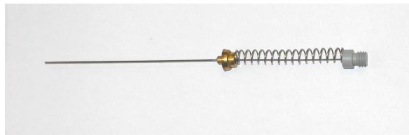
Slika 17. Vlakno sa ovojnicom DVB/CAR/PDMS (sivo vlakno)<sup>30</sup>
