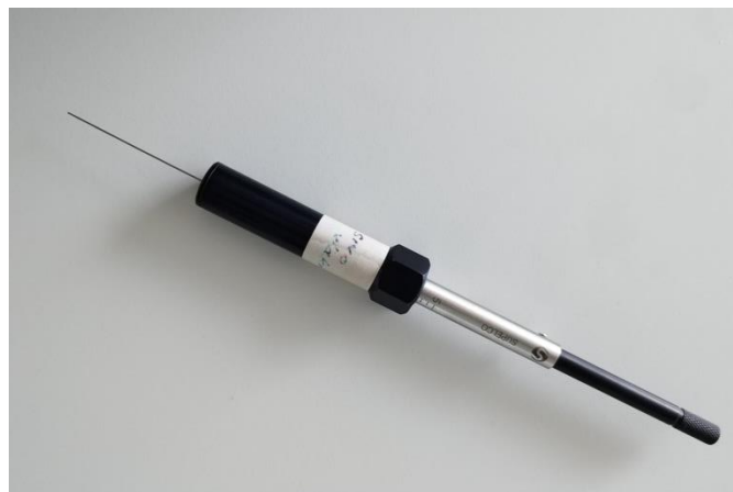
Slika 19. Uređaj za mikroekstrakciju (vlastita fotografija)
