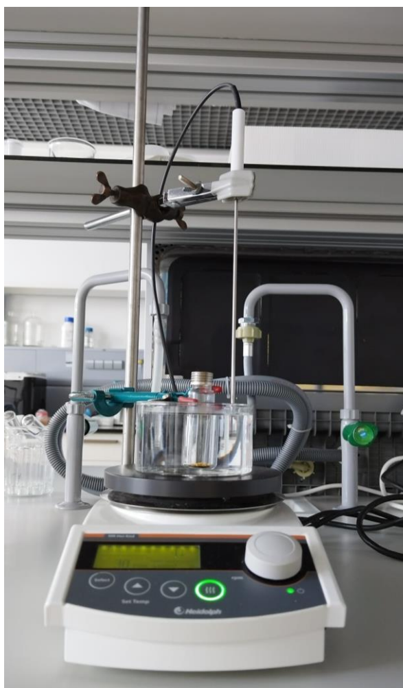
Slika 16. Aparatura za mikroekstrakciju vršnih para na krutoj fazi (HS-SPME) (vlastita fotografija)
