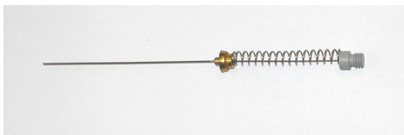
Slika 17. Vlakno sa ovojnicom DVB/CAR/PDMS (sivo vlakno) 30
