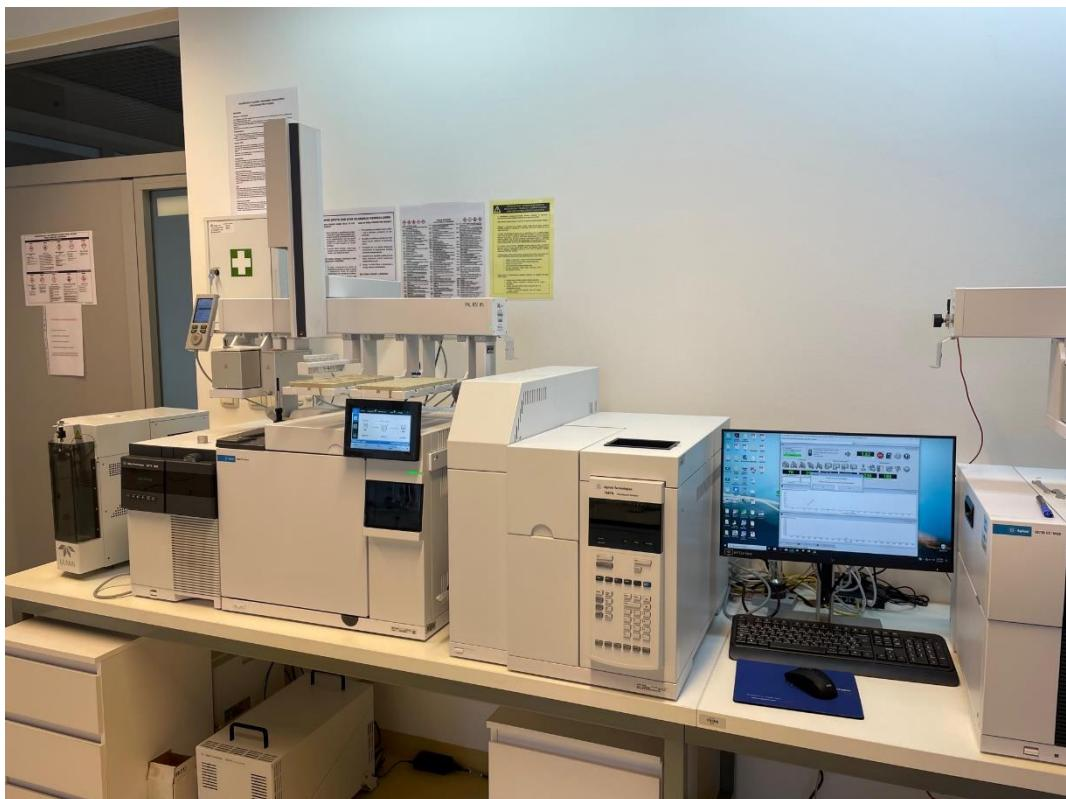
Slika 11. Vezani sustav plinska kromatografija-spektrometrija masa (GC-MS)
