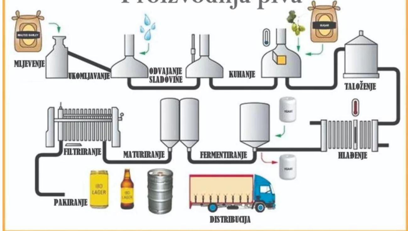
Slika 1. Tehnološka shema proizvodnje piva<sup>9</sup>
