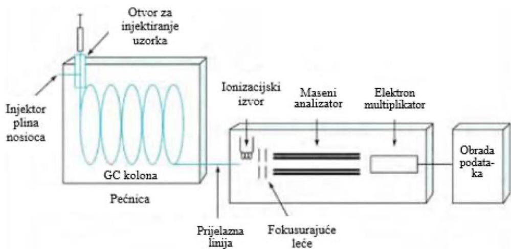
Slika 5. Shematski prikaz GC-MS uređaja<sup>32</sup>
