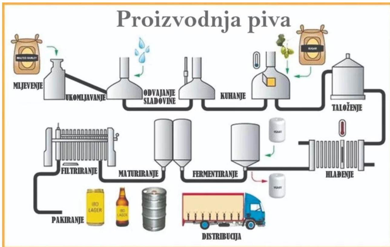
Slika 1. Tehnološka shema proizvodnje piva 9
