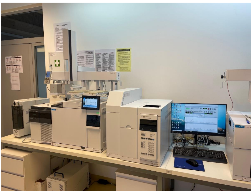
Slika 11. Vezani sustav plinska kromatografija-spektrometrija masa (GC-MS)
