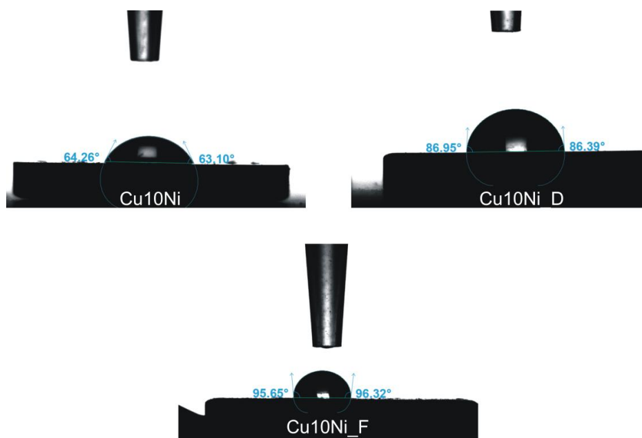
Slika 31. Kontaktni kut koji kapljica vode zatvara sa nemodificiranom i modificiranom površinom Cu10Ni legure
