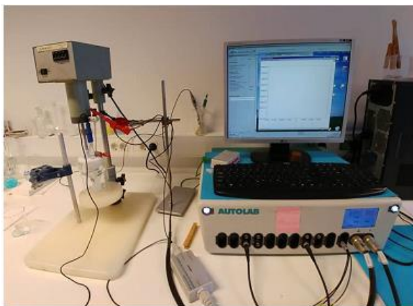
Slika 13. Uređaj za elektrokemijska mjerenja
