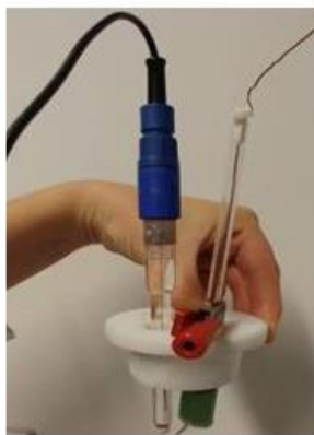
Slika 15. Referentna elektroda (lijevo) i protuelektroda (desno)
