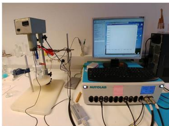
Slika 13. Uređaj za elektrokemijska mjerenja
