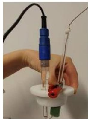
**Slika 15.** Referentna elektroda (lijevo) i protuelektroda (desno)
