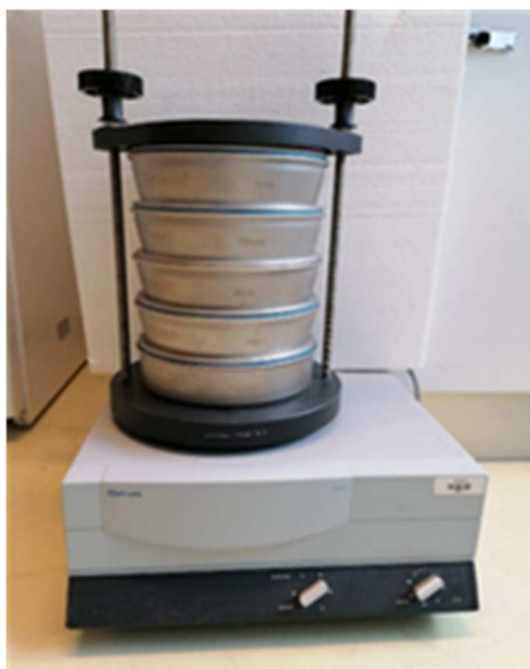
Slika 2.3. Laboratorijski uređaj za prosijavanje "Retsch AS200 basic"
