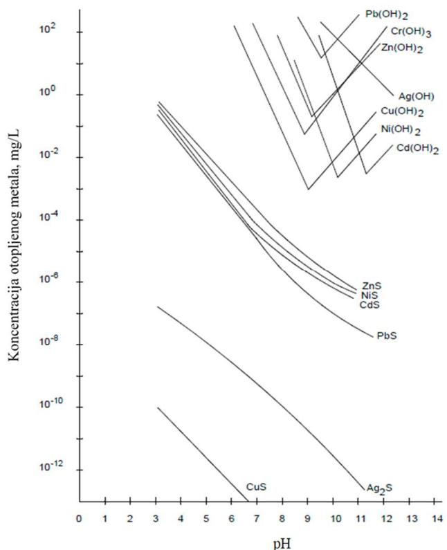
Slika 1.4. Specifični pH za taloženje metala u obliku hidroksida i sulfida<sup>10</sup>
