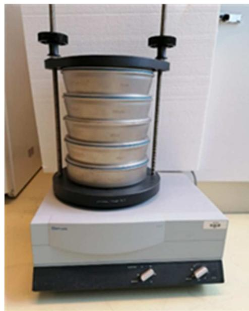
Slika 2.3. Laboratorijski uređaj za prosijavanje "Retsch AS200 basic"
