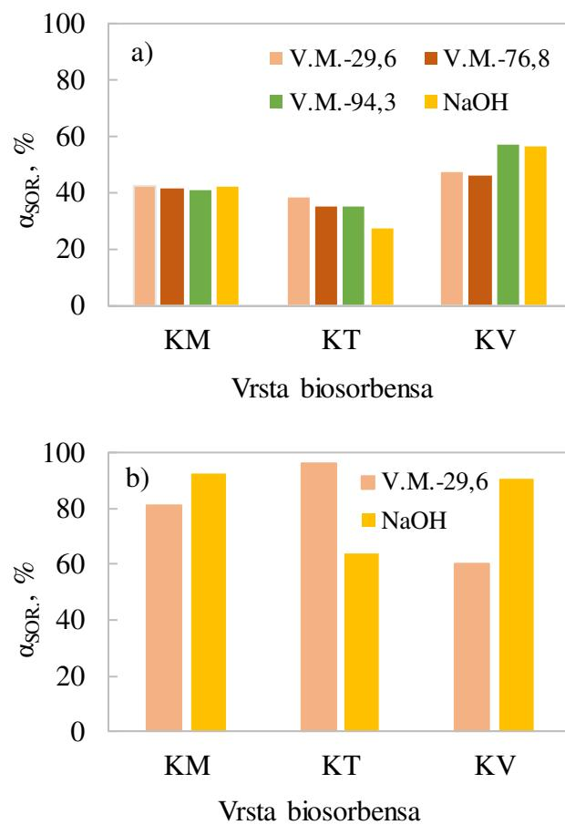
Slika 3.6. Učinkovitost uklanjanja cinka soprcijom na KM, KT i KV nakon kemijskog taloženja u području: a) pH=7,0-7,5 i b) pH=8,0-8,5
