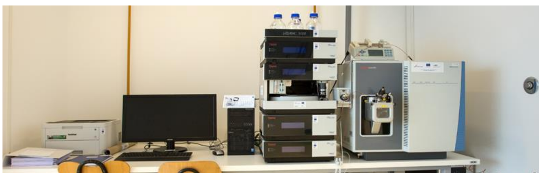
Slika 9. Primjer izgleda tekućinskog kromatografa 32
