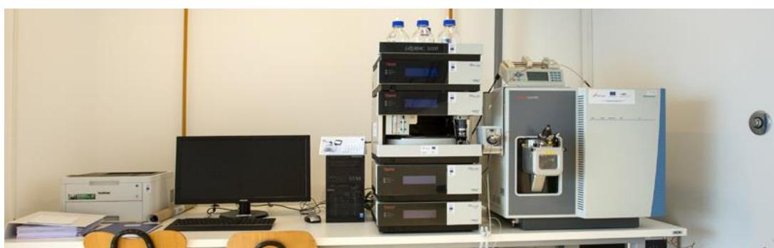
**Slika 9.** Primjer izgleda tekućinskog kromatografa<sup>32</sup>
