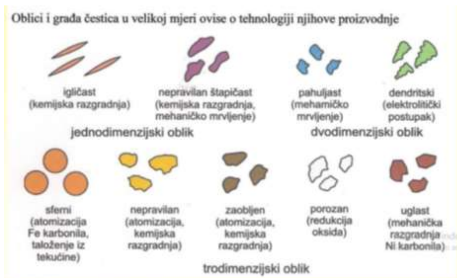
Slika 2. Oblici čestica praha i metode njihova dobivanja 6
