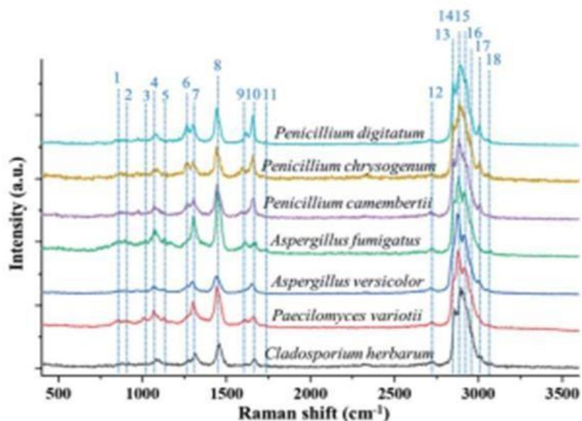
**Slika 2.** Pojedinačni Ramanovi spektri sedam različitih uzoraka gljiva zarobljenih u reakcijskoj komori pod kontrolom okoliša.<sup>7</sup>
