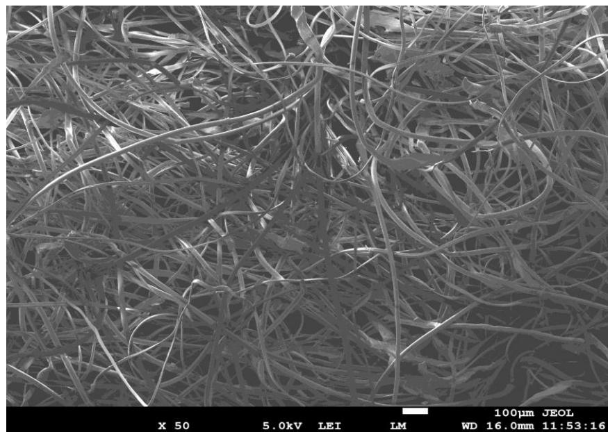
**Slika 19.** Prikaz strukture slijepe probe na uvećanju od 50 puta.
