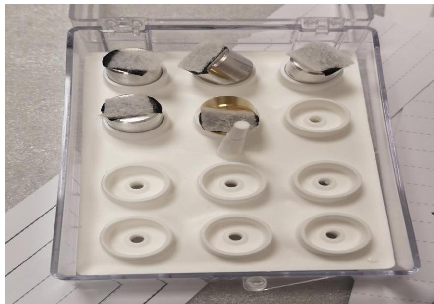
**Slika 9.** Priprema uzoraka za SEM.
