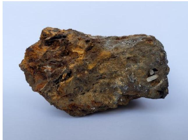
*Slika 4 – Limonit (sastoji se od getita, hidrohematita i lepidokrokita)<sup>9</sup>*
