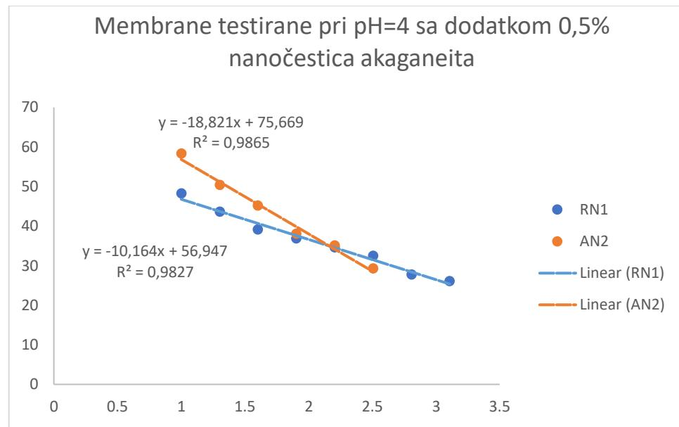
*Slika 9.* - Ovisnost elektrodnog potencijala membrane AN2 o koncentraciji niklovih iona pri pH=4
