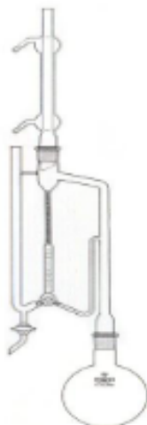
Slika 3. Aparatura po Ungeru.
