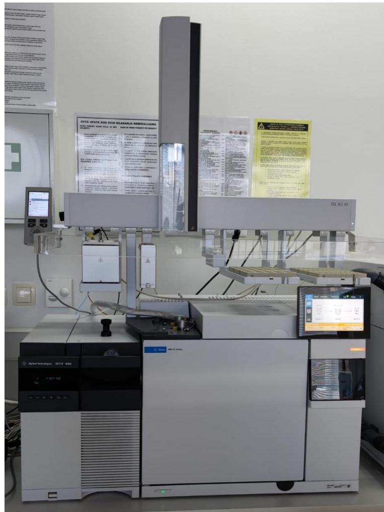
Slika 10. Prikaz plinske kromatografije sa spektrometrijom masa.
