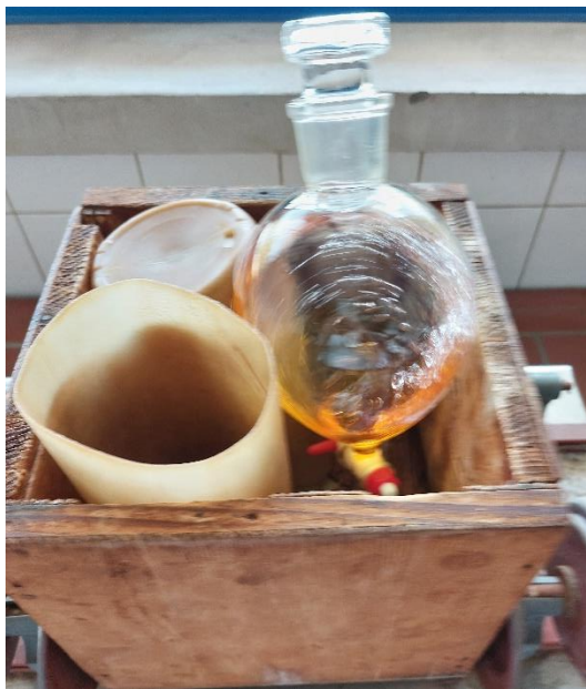
Slika 23. Mućkanje reformat benzina i jod-monoklorida
