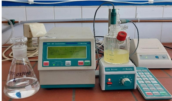
Slika 22. Aparature za određivanje vode metodom Karl Fischerove kolumetrijske titracije
