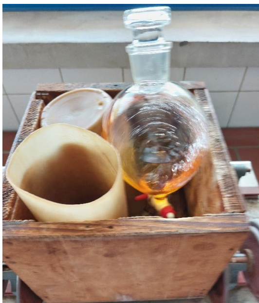
Slika 23. Mućkanje reformat benzina i jod-monoklorida
