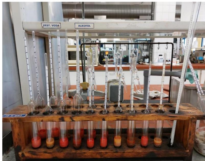
**Slika 14.** Prikaz areometara i termometara korištenih u RNR
