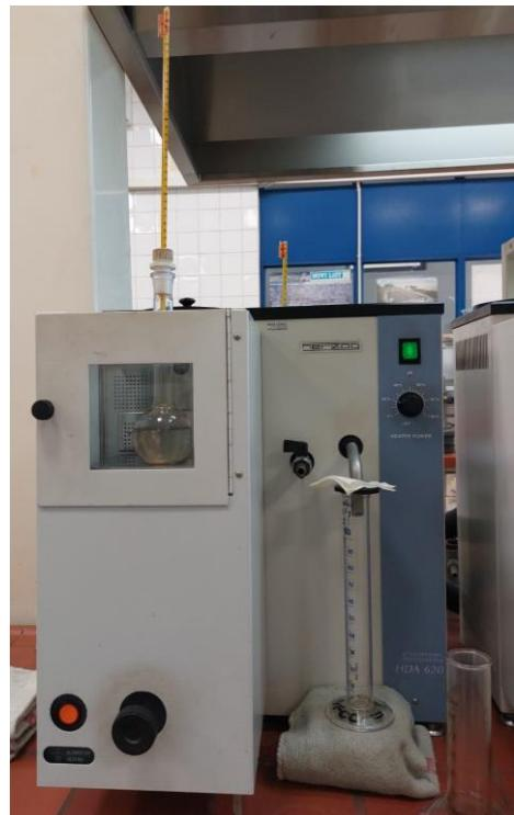
**Slika 18.** Aparatura za ručnu destilaciju
