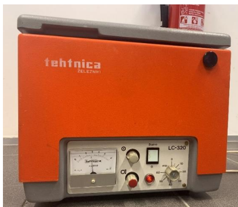
Slika 12. Centrifuga (Tehtnica železniki, LC-320)
