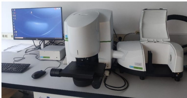
Slika 22. FT-IR spektrometar Spectrum Two, Perkin Elmer
