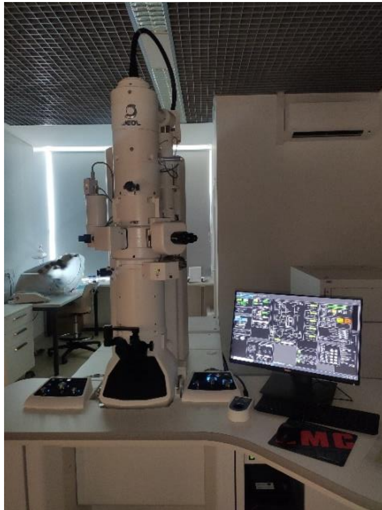
Slika 15. Jeol JEM 1400Flash elektronski mikroskop
