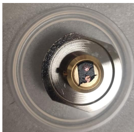
Slika 19. Nosač uzorka za snimanje na SEM-u
