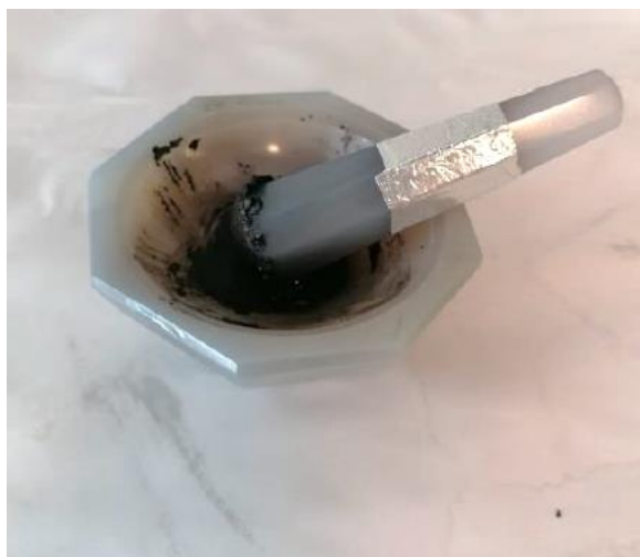
Slika 22. Pripremljena pasta ujednačenog sastava
